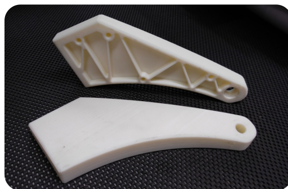
Figura 2. Prototipos de brazos para el chasis de la moto, generados por fabricación por adición
