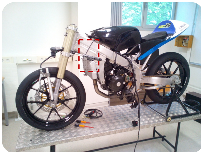
Figura 3: Piezas definitivas fabricadas en aluminio y soldadas al chasis
