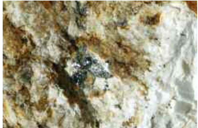
Fig. 3.1.36. Pequeña mancha de galena (sulfuro de plomo) en una muestra de barita.
