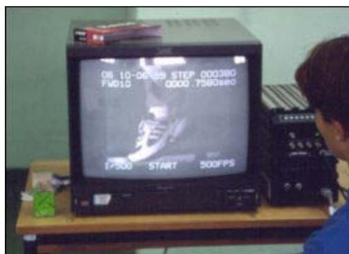
Figura 6: Protocolo utilizado para medir el tiempo de vuelo durante el salto mediante fotogrametría. Imagen digital a 500Hz.
