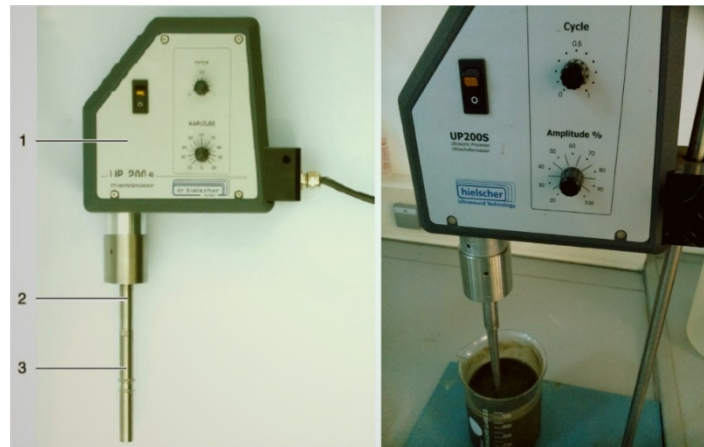
Figura 3.10 Esquema-Fotografía del Procesador de Ultrasonido: (1) Procesador, (2) asta, (3) sonotrodo
