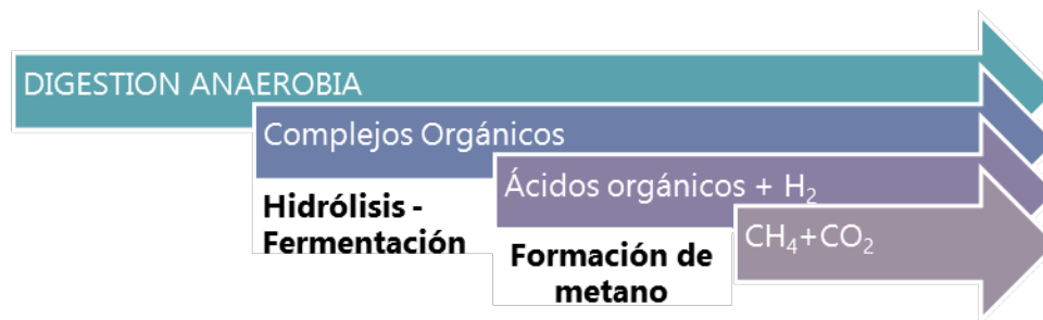
Figura 2.4 Esquema del proceso de digestión descrito en dos etapas
