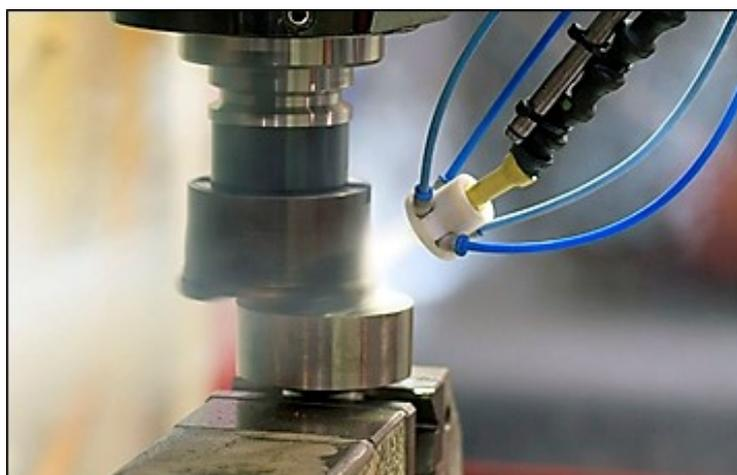
Figura 3.19: Adaptador convergente CryoMQL aplicado al fresado
