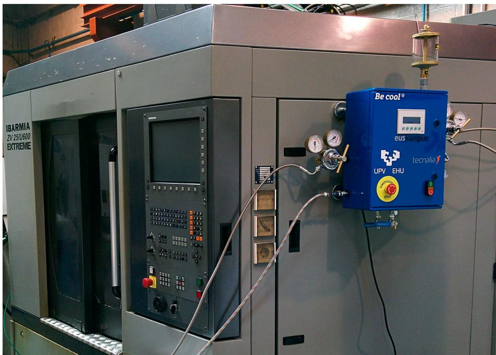
Figura 6.3: Equipo CryoMQL instalado en Ibarria ZV-25
