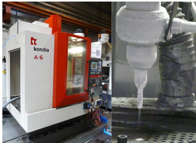
Figura 4.19: Montaje experimental para el taladrado de composite CFRP-Ti6Al4V
