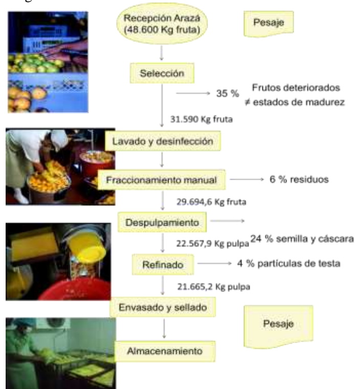
Figura 12. Diagrama de flujo transformación del fruto de arazá para obtención de pulpa. El aproximado de los pesos se da a partir de la producción anual actual. Se hacen los pesajes con el ánimo de generar registros de trazabilidad.
