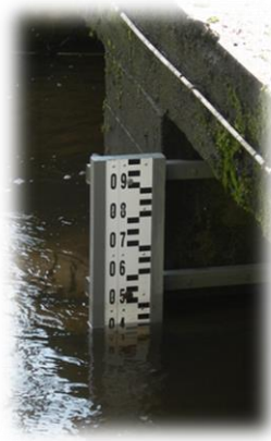
Figura 4.13 Limnómetro o Escala limnimétrica.
