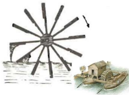
Figura 1.9 Esquema de Rueda colgante.
