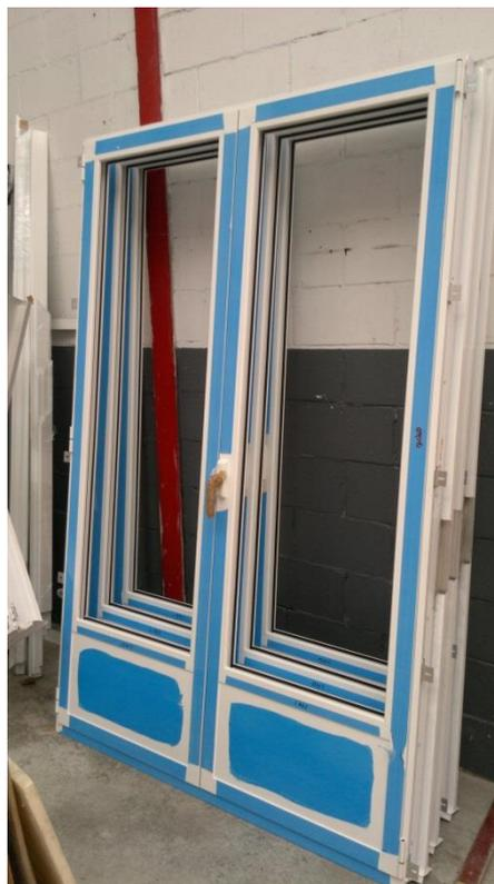
*Foto N°3 (Estructura de aluminio de la ventana ya montada)*
