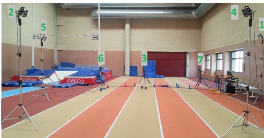
FIGURA 7. Espacio de grabación con la disposición de las 7 cámaras numeradas y los tacos de salida en la calle 4
