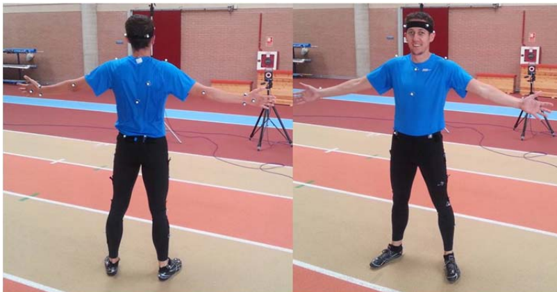
FIGURA 6. Modelo de 35 marcadores (PlugInGait Full Body) con el que se realizó el estudio (Plano frontal anteroposterior).
