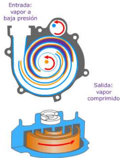
Figura 2.22.- Esquema de funcionamiento de un compresor Scroll
