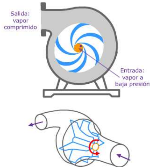
Figura 2.23.- Esquema de funcionamiento de un compresor centrífugo
