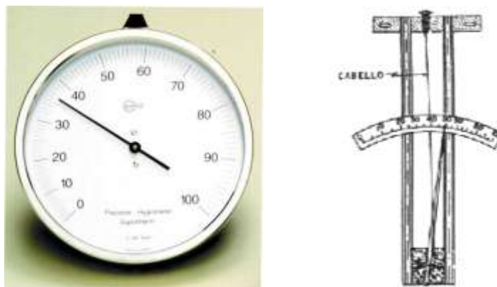
Figura 1.4.- Esquema de un higrómetro de cabello y su imagen real
