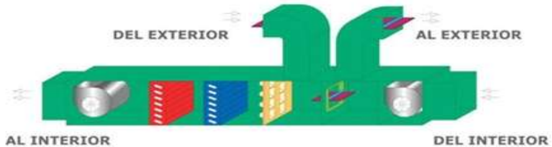
Figura 6.3.- Esquema de UTA con enfriamiento gratuito
