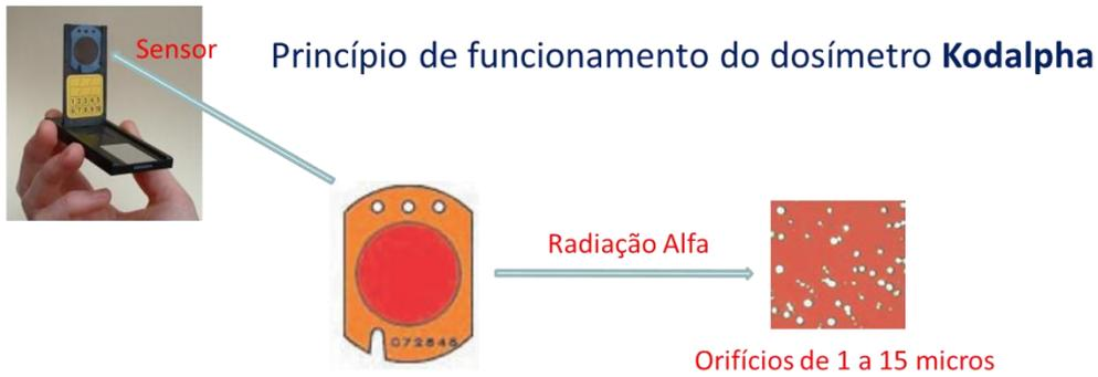
**Figura 50 - Princípio de funcionamento do dosímetro de radiação alfa**
