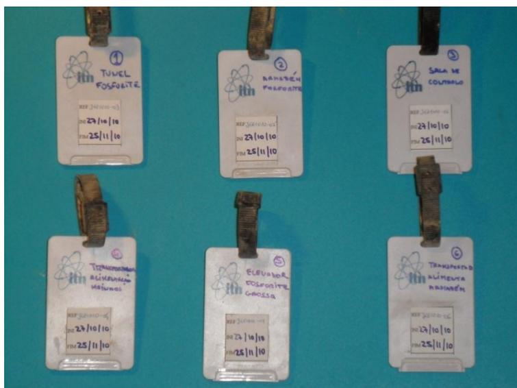
**Figura 65 - Detetores de traços nucleares usados para a monitorização do radão**
