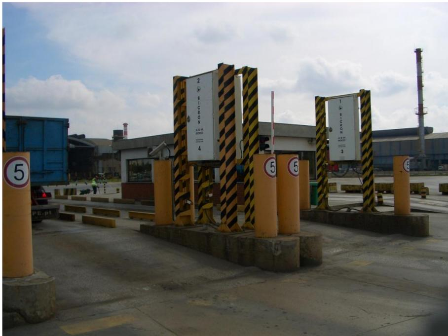
**Figura 86 - Pórtico instalado na Siderurgia Nacional para deteção de radiação**
