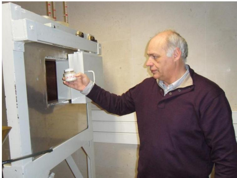
**Figura 67 - Colocação pelo autor de uma amostra selada dentro da cabine de medição do ITN**
