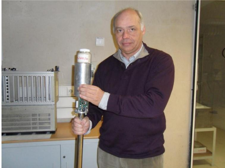
**Figura 68 - Detetor de germânio usado na espectrometria gama**
