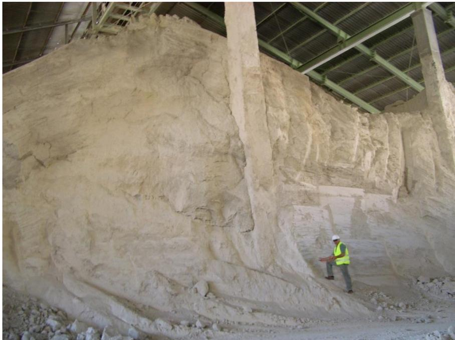
**Figura 9 - Medición de la radiación gamma en el almacén de los superfosfatos**
