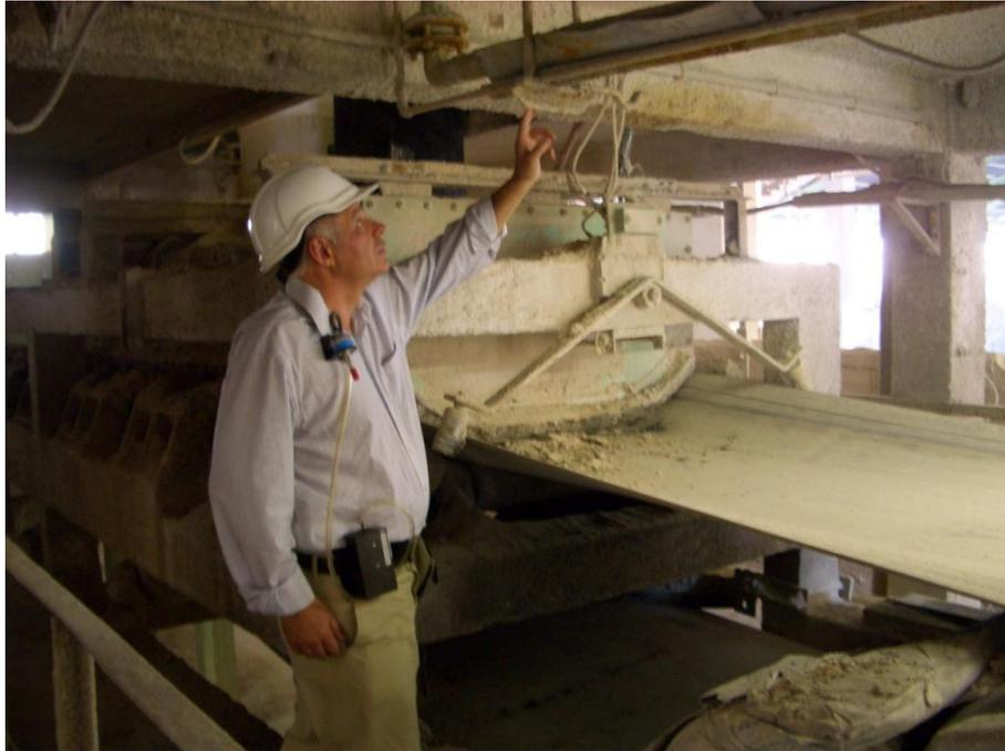
**Figura 60 - Autor efetuando a medição de poeiras com bomba de aspiração**
