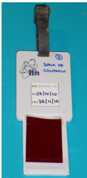
**Figura 66 - Película exposta à radiação alfa originada pelo radão**
