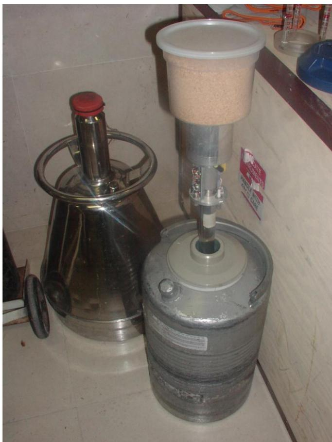
**Figura 48 - Medição da radiação gama numa amostra de fosforite**
