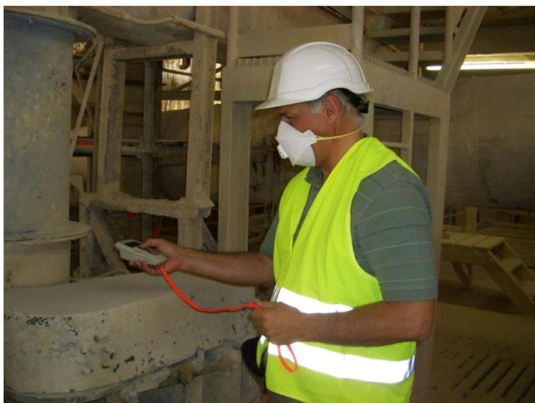
**Figura 57 - Autor realizando a medição da radiação gama em equipamentos**
