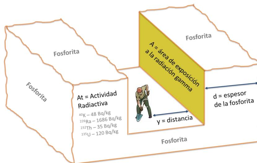
Figura 13 - Dibujo esquemático para simular la exposición del trabajador a la fosforita
