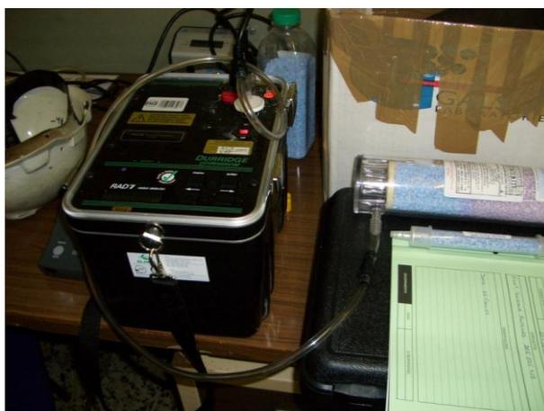
**Figura 63 - Equipamento de deteção de radão marca DURRIDGE**
