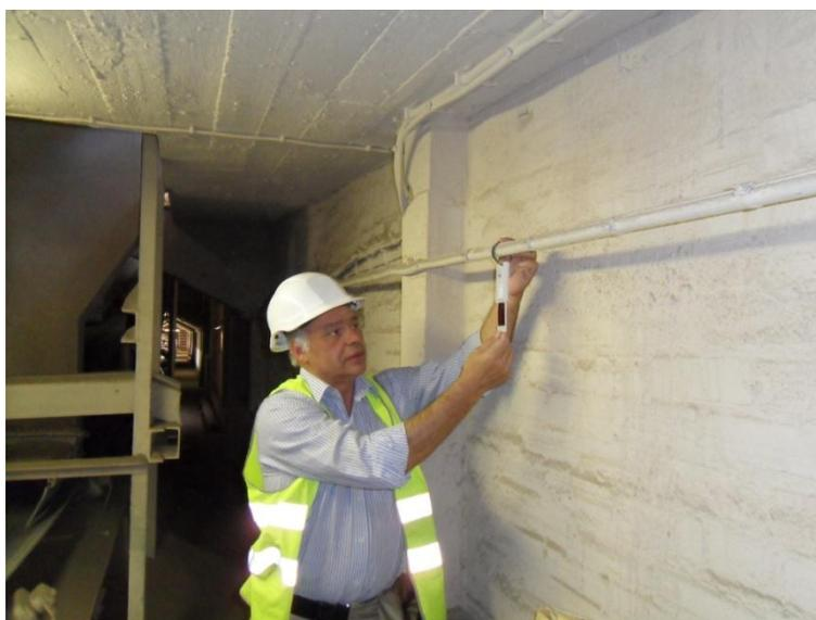
**Figura 64 - Autor instalando um dosímetro para determinação da concentração de radão**
