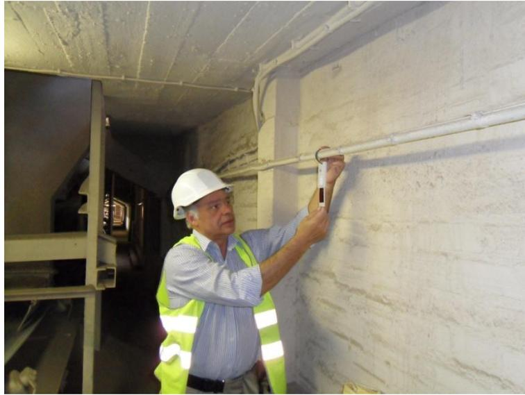
**Figura 10 - Instalación de un detector de trazas nucleares para medir el radón**
