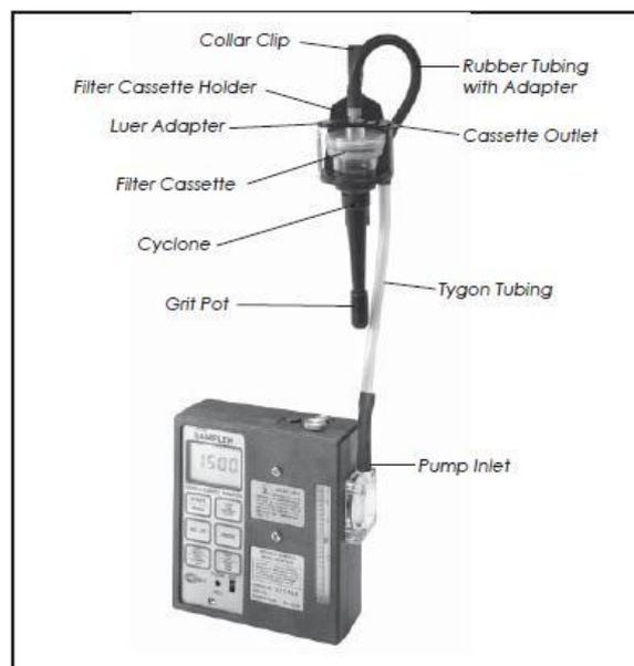
Figura 58 - Conjunto de amostragem bomba de aspiração e ciclone
