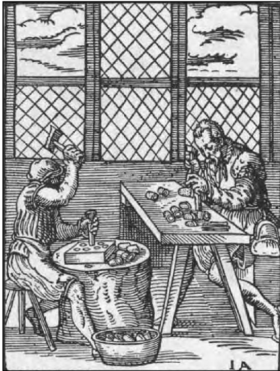
Fig. 89: fabricación de dedales mediante la técnica del embutido. Jost Amman (1568): El libro de las profesiones (Das Ständebuch) .
