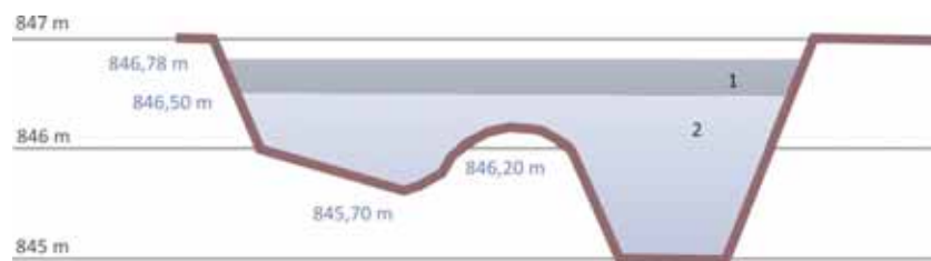
Figura 10. Perfil de la primera balsa, laguna de micrófitos (BW). Redibujado a partir del Plano 6. Estado final de las balsas, del Proyecto básico y de ejecución de la depuradora de macrófitos de Bustillo de Cea. 1.- Nivel del agua con aportación de agua de lluvia. 2.- Nivel del agua en condiciones normales.
