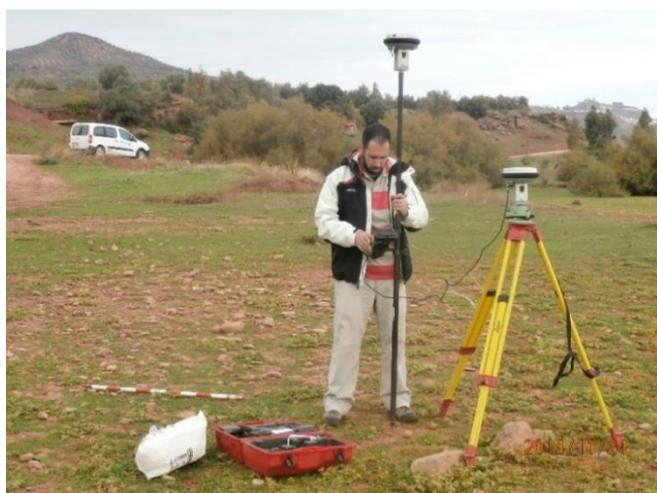
**Figura 260.** Montaje del equipo Leica GS15, compuesto por un receptor fijo y móvil en el campo
