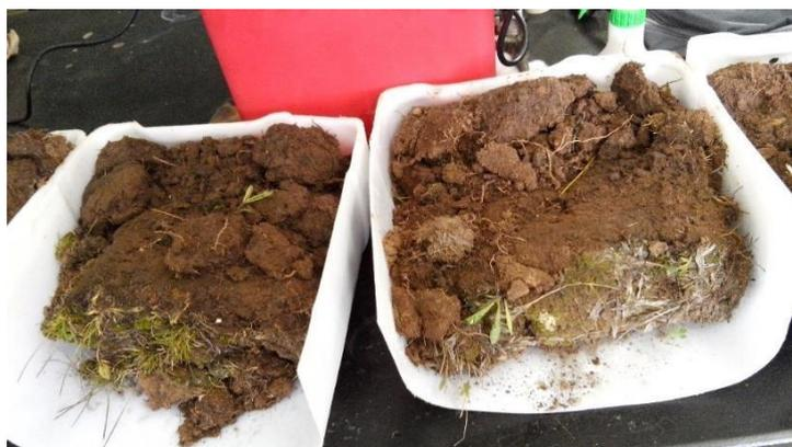
**Imagen 3.** Las imágenes muestran el a) corte, b) depósito y c) transporte al laboratorio de los bloques de suelo (monolitos) utilizados para la realización del experimento.
