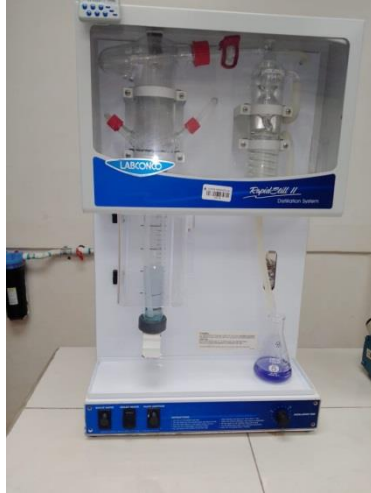
Ilustración 29 Equipo de destilación
