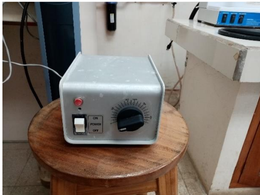
Ilustración 24 Controlador del bloque digestor
