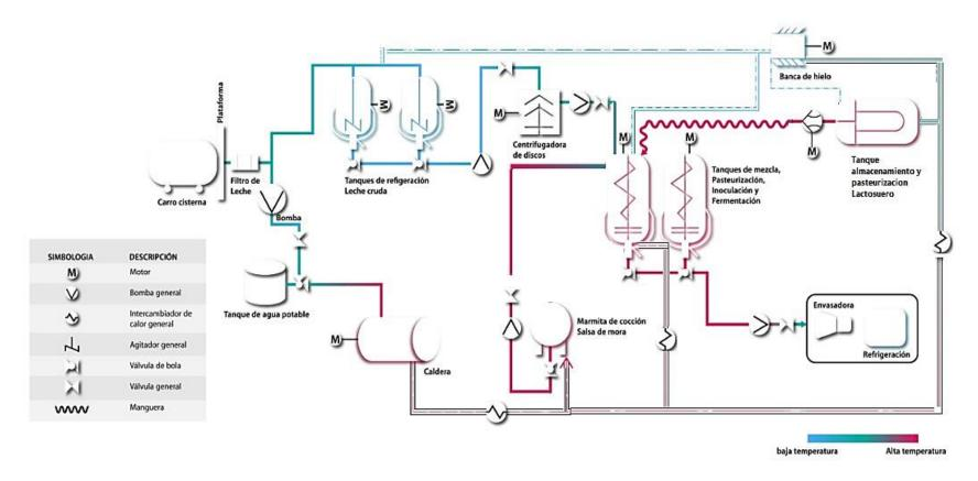
Nota: la figura es un diagrama de tuberías e instrumentación que indica la secuencia de las operaciones, proceso y equipos para la elaboración del producto .Fuente: Elaboración partir de datos de la investigación.
