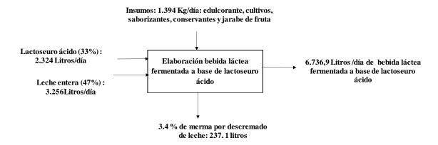
Nota. Se observa las entradas de materias primas e insumos requerido para elaborar el producto a base de lactosuero. Como salida del proceso se tiene la producción de litros/día de bebida y el % de merma del proceso.
