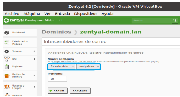
Imágen 32. Configuración intercambiadora de correo en DNS
