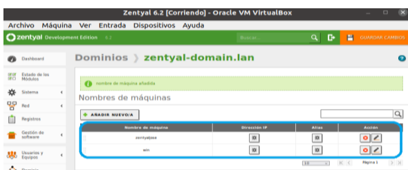
Imágen 30. Creación de nuevas máquinas en DNS
