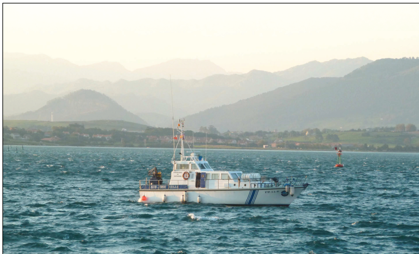
Figura 1. El B/O José Rioja de 15.8 m de eslora y 1.1 m de calado realizando trabajos oceanográficos en la bahía de Santander.
