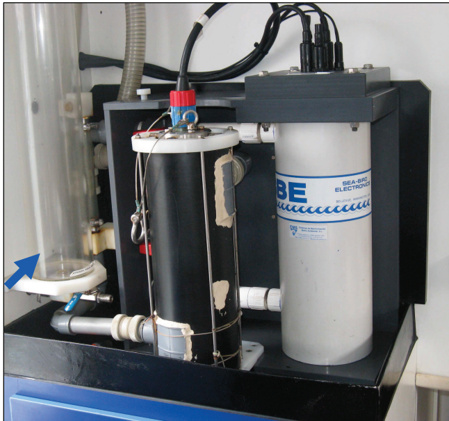
Figura 2. TSG instalado en el B/O José Rioja (cilindro blanco). Lleva un desburbujador (flecha azul) para eliminar las burbujas que se forman al pasar por el circuito de aspiración, que afectan principalmente a la determinación de la salinidad. El cilindro negro es un fluorómetro.
