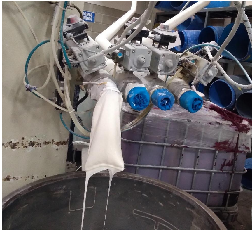
Figura 2.5. Filtrado por malla de 250 micras en la salida del tanque.
