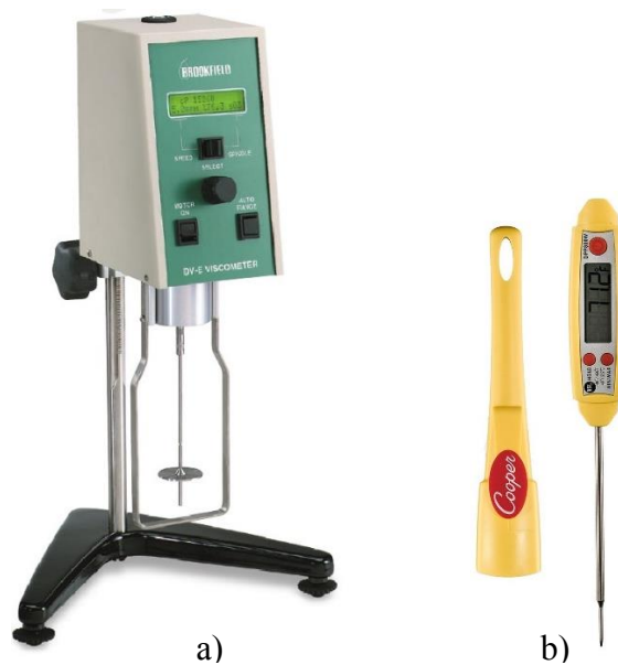
Figura 4.2. Equipo de laboratorio utilizado; a) Viscosímetro Brook Field (tolerancia de \pm 50 cP); b) Termómetro Cooper Atkins (tolerancia de \pm 0.1 °C).
