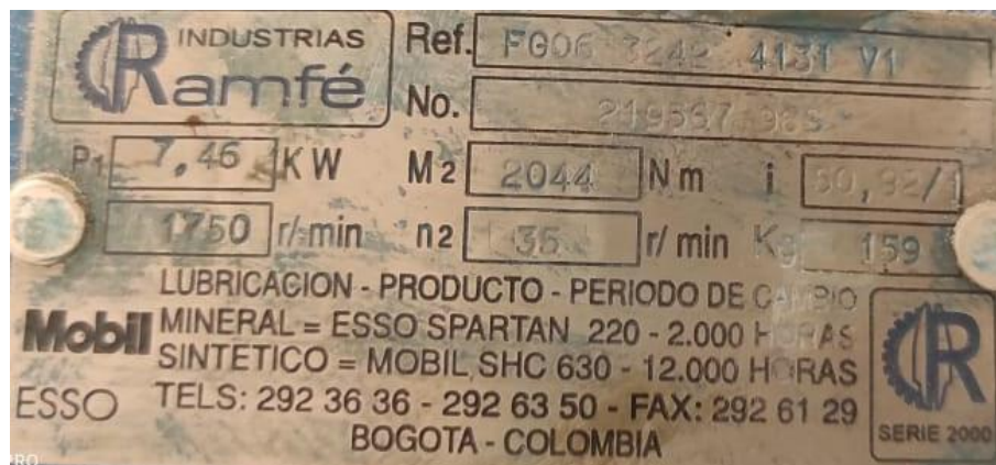
Figura 4.3. Placa de información de la caja reductora de velocidad de los tanques de agitación.
