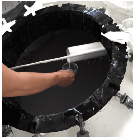
Figura 4.5. Extracción del Plastisol de un tanque de almacenamiento.
