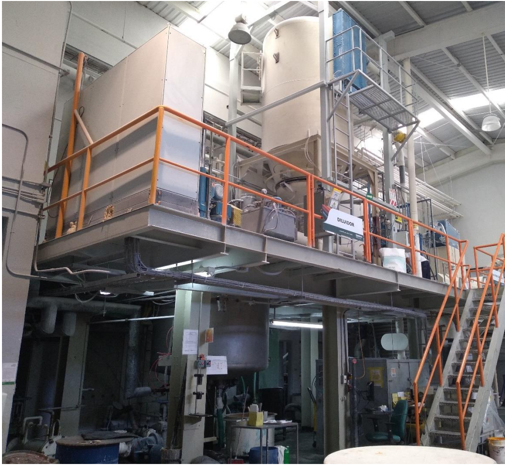
Figura 2.2. Tanque almacenador (superior) y mezclador (inferior) para la preparación del Plastisol.
