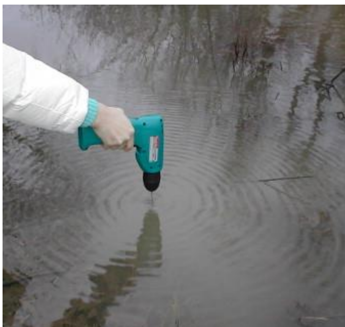
Fig. 1. Muestreador on-site propuesto por Quin et al. basado en el empleo de TFME. Reproducida con permiso de la referencia [16]. Copyright 2009 Elsevier B.V.
