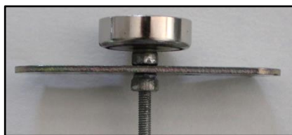
Fig. 3. Unidad de extracción magnética con aspas de mayor tamaño (Capítulo 3).
