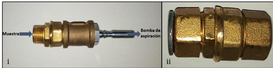
Fig. 3. Unidad de muestreo de aire propuesta por Alcudia-León et al. (i) Unidad de muestreo empleada en la etapa de toma de muestra. (ii) Unidad de muestreo preparada para la etapa de análisis. Adaptada con permiso de la referencia [21]. Copyright 2017 Elsevier B.V.
