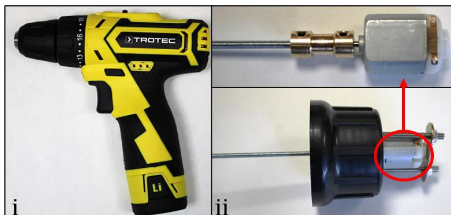
Fig. 6. Dispositivos para proveer agitación en los muestreadores diseñados. (i) Taladro de batería empleado en los Capítulos 2 y 3 . (ii) Pequeño motor eléctrico empleado en el Capítulo 4 .
