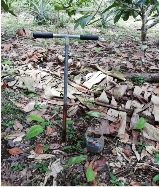
Foto 3. Equipo de muestreo de suelos
