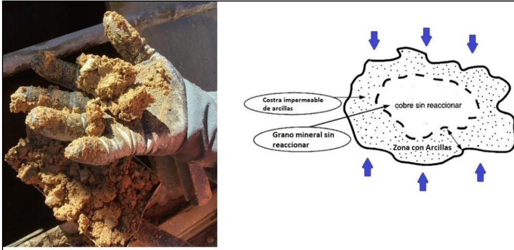
Fotografía 3. Mineral aglomerado con alto contenido de arcillas. Ejemplo de curado en un grano mineral con arcillas (Derecha).
