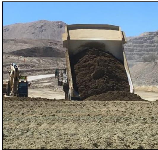
Fotografía 5. Descarga de glomeros en pila de lixiviación.
