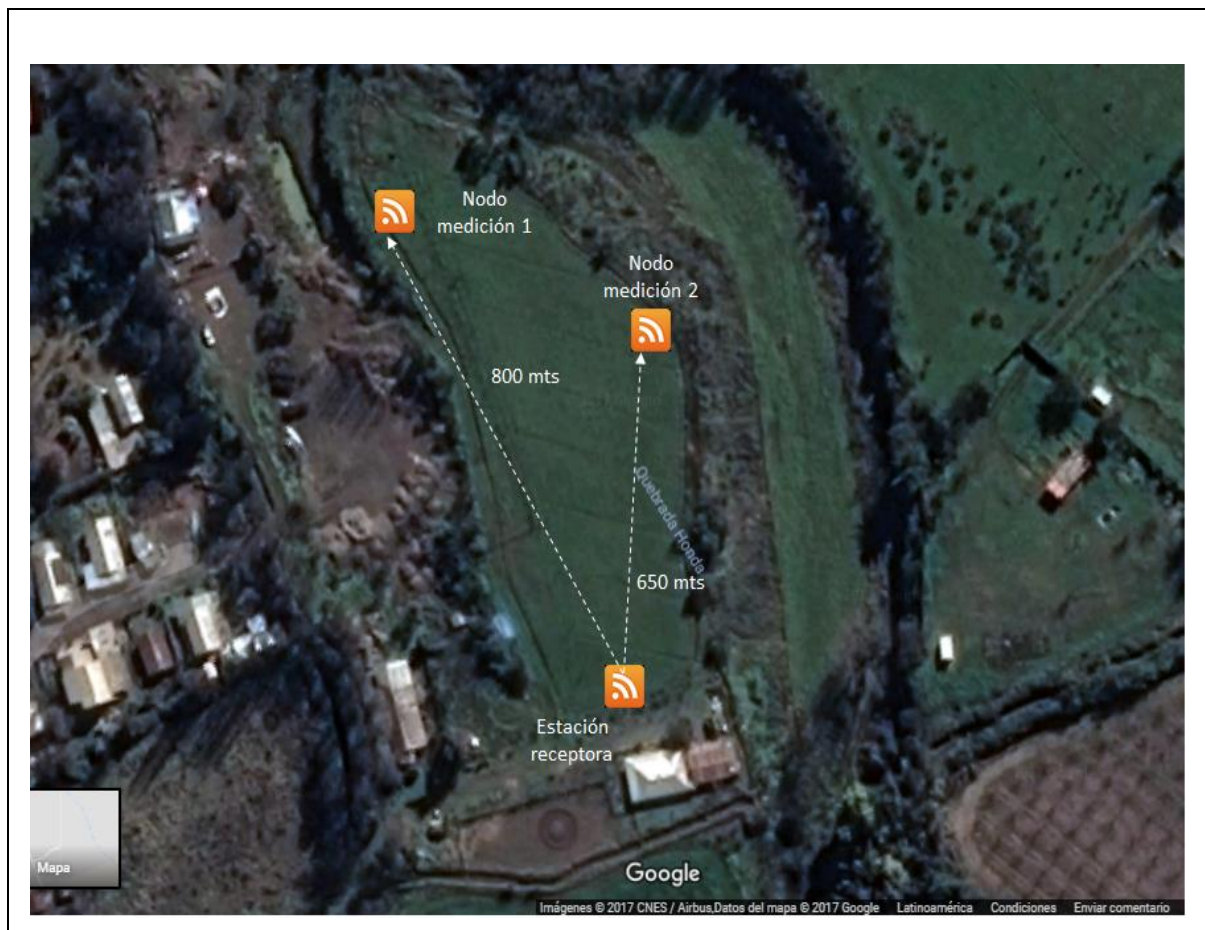
FIGURA 71: Esquema de zona de pruebas de alcance de red sensores
