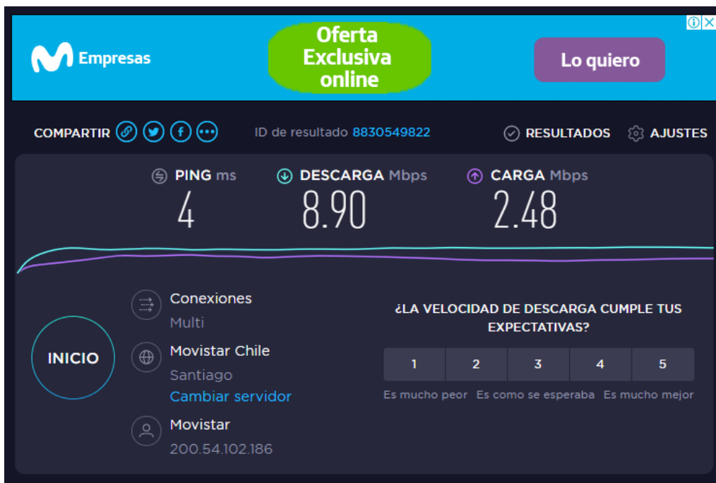
Ilustración 100 – Prueba de medición de ancho de banda en equipo cliente final (Elaboración propia, 2019).
