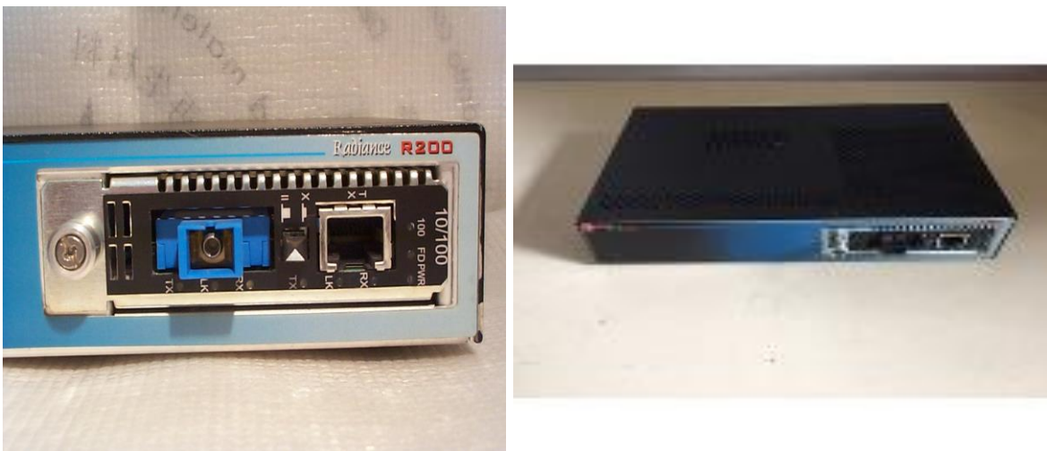
Ilustración 25 – Conversor de medios (Telco System, 2019).
