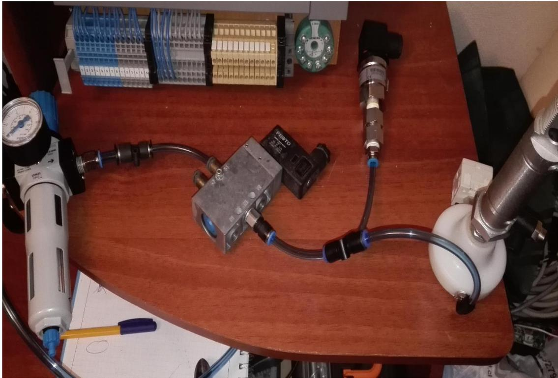
**Figura IV.7:** Circuito de inyección de Aire Comprimido.
