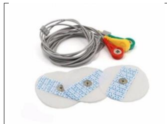
Figura 16, Cable de sensor con 3 electrodos. (Sparkfun, 2017)
