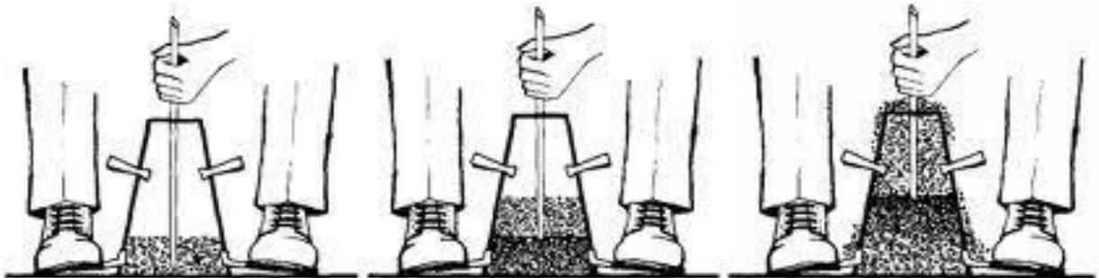
Figura 2.2: Llenado y compactación de capas. (Fuente NCh.1019)
