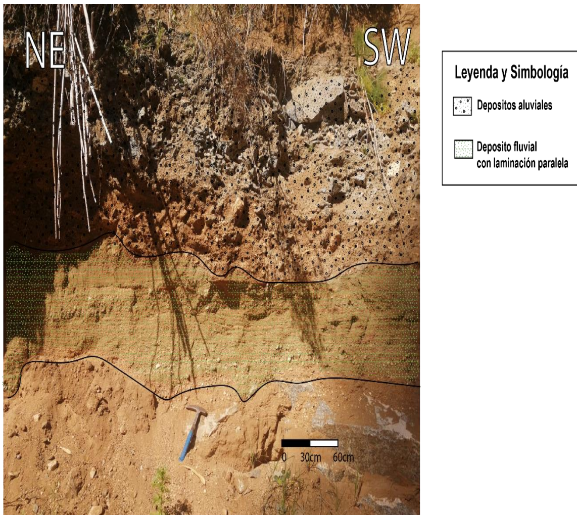
Fotografía 4. Unidad fluvial-aluvial con presencia de laminación paralela. Coordenadas: 33°03'50''S 71°36'03'' W.
