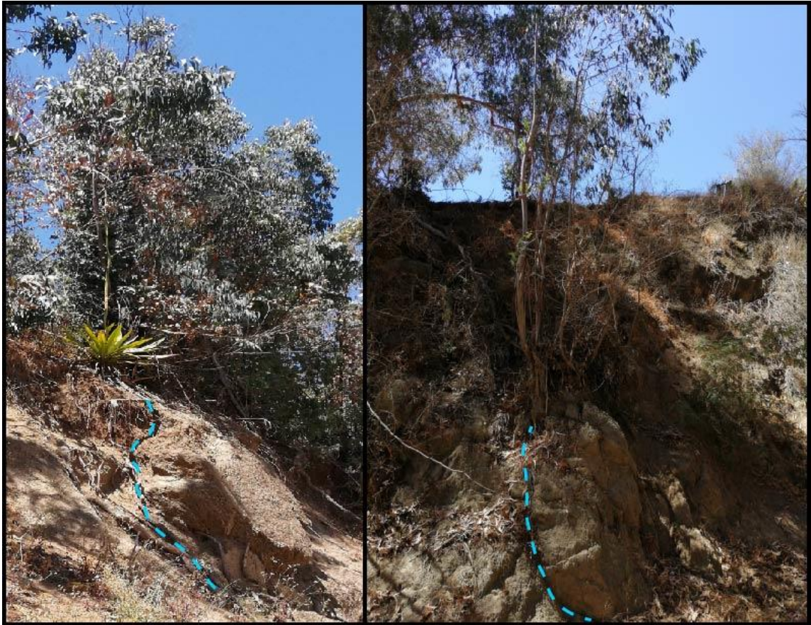
Fotografía 2. Fotografías de Eucalyptus globulus afectando al macizo rocoso mediante la interacción de sus raíces y las discontinuidades presentes.
