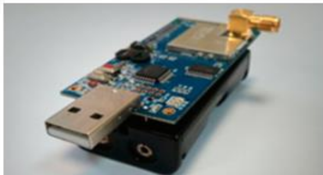
Figura 78; Nodo Sensor de la marca Advantics CM5000 SMA
