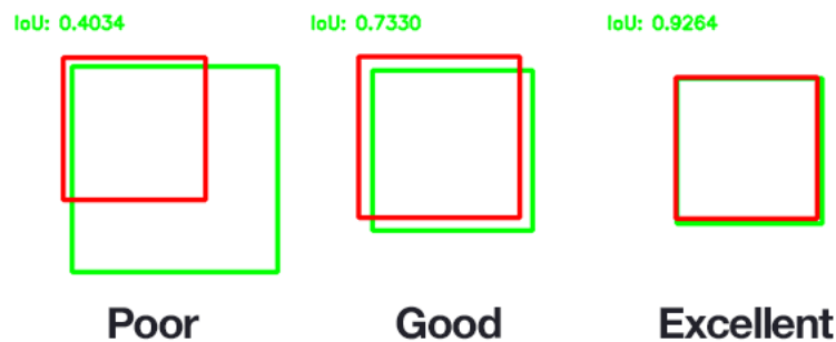
Figura 3.29: Ejemplo de métrica IoU para varios bounding boxes [19].
