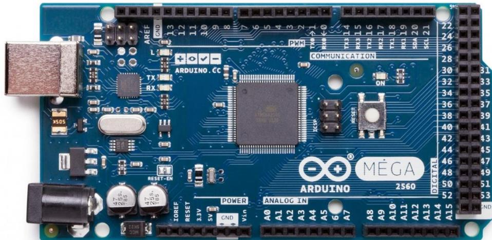
Figura 1.8: Controlador Arduino Mega
