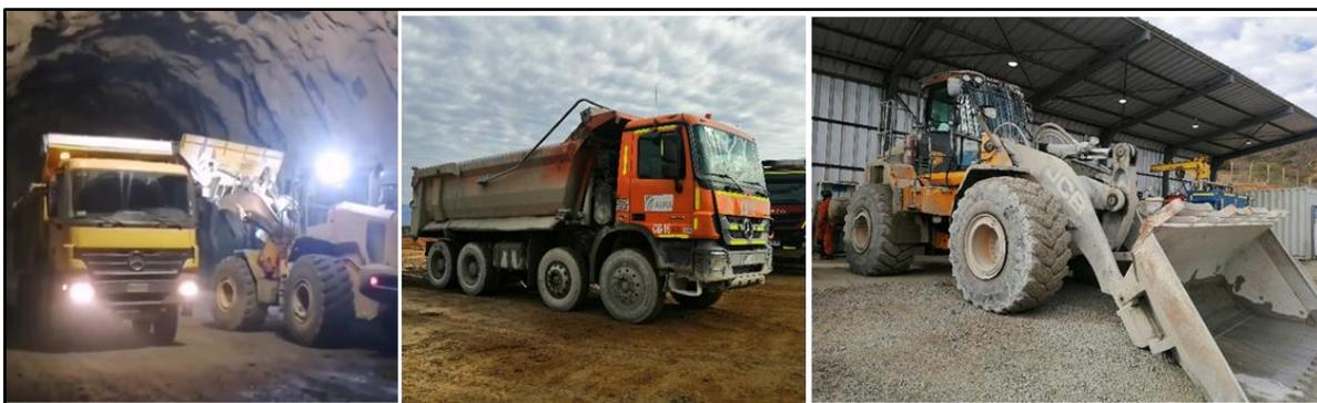
Fotografía 10 Extracción de marina, camión tolva Mercedes Benz 20 M<sup>3</sup> y cargador frontal articulado JCB
