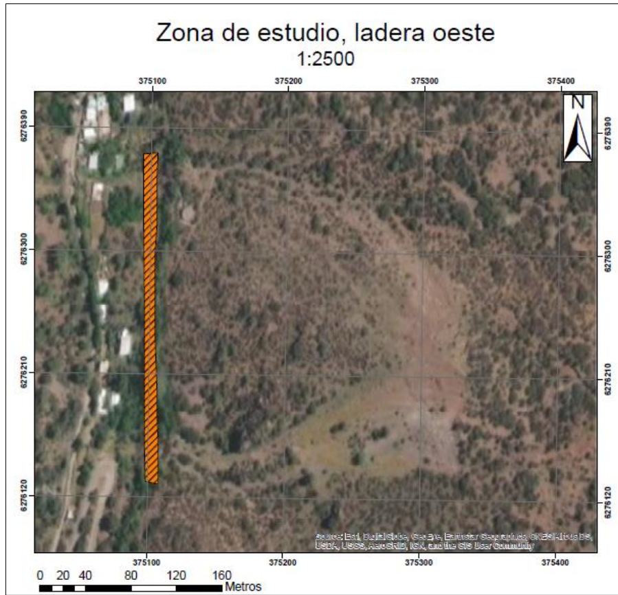
Figura 49: Ubicación sugerida del muro de contención. NOTA: Las dimensiones del trazado del muro no son consistentes con la escala del mapa, fueron exageradas para efectos de la ilustración.
