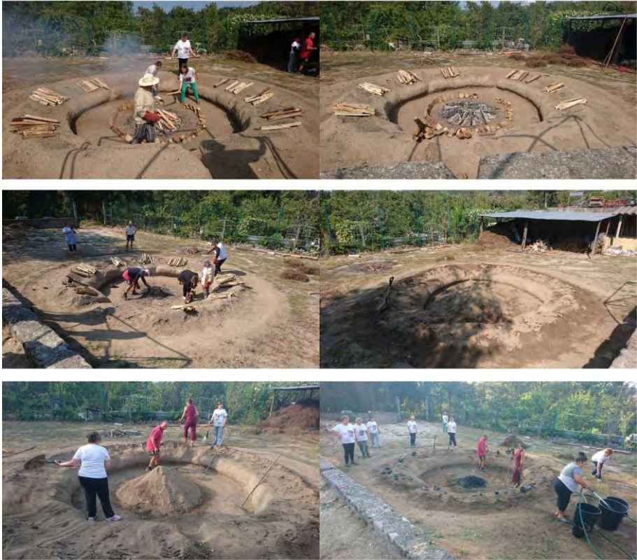
Figura 283. Cocedura mediante soenga de arriba a baixo en orde do proceso. 81
