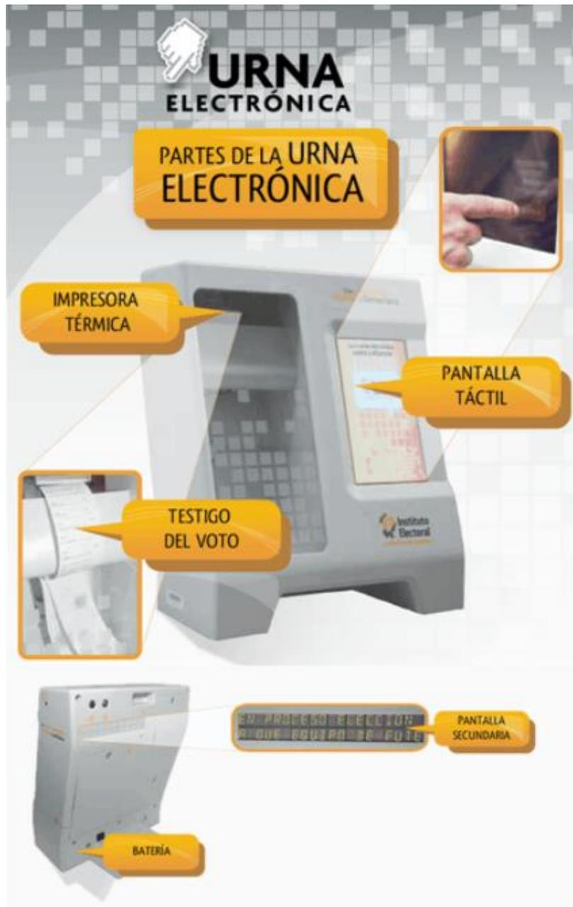
Ilustración 18. Partes de la Urna Electrónica de Hidalgo. (La Silla Rota, 2020)
