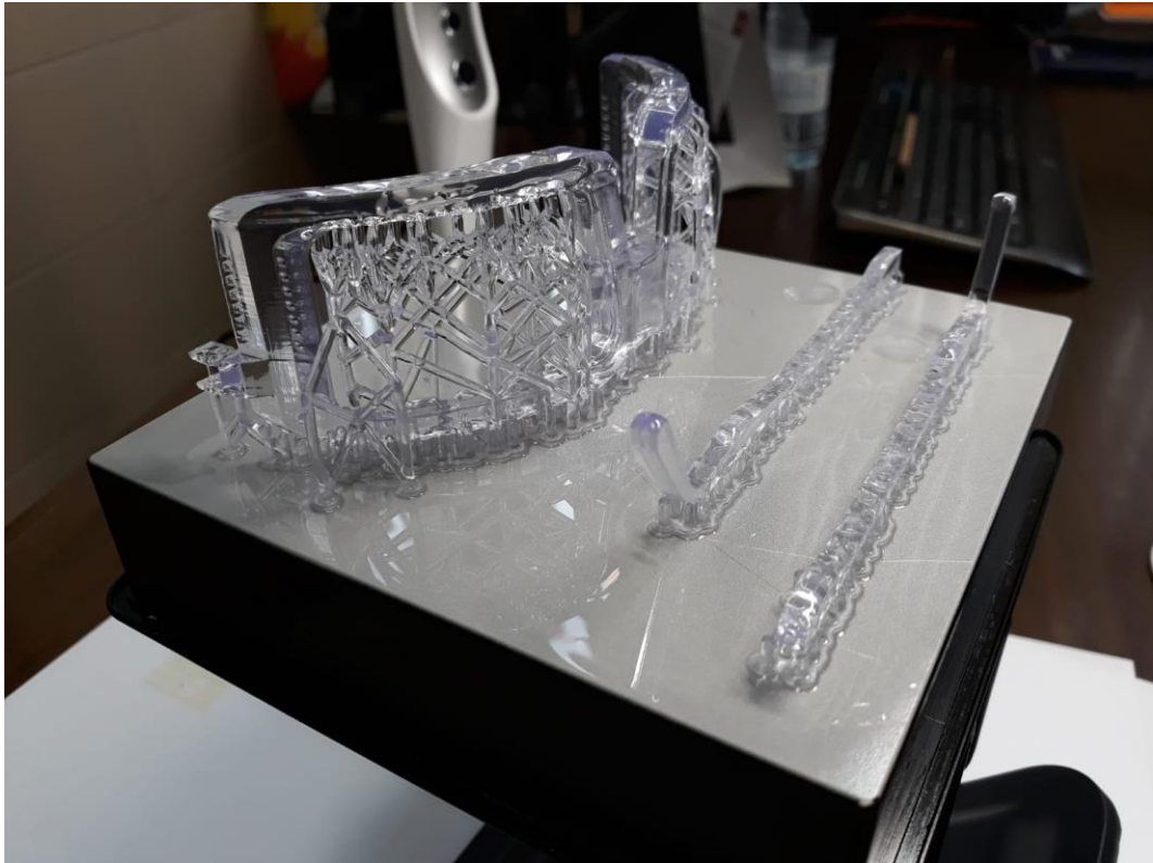
Ilustración 26: Piezas de la montura extraídas de la impresora 3D.
