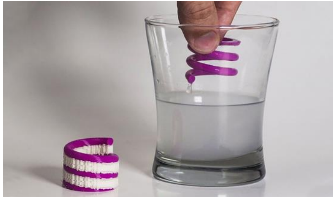
Ilustración 10: HIPS como soporte se disuelve en producto químico. (Tresdpro, 2021)
