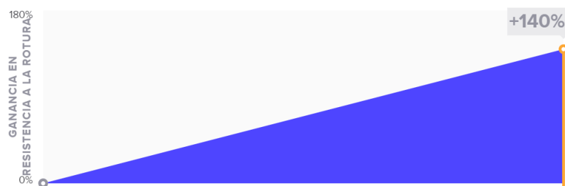
Ilustración 27: Datos de fotocurado Flexible 80A Resin (Formlabs, Form Cure: ajustes de tiempo y temperatura, 2021).
