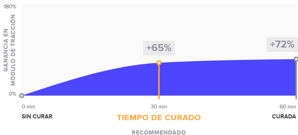
Ilustración 32: Tiempo de curado Grey Resin. (Formlabs, Form Cure: ajustes de tiempo y temperatura, 2021)
