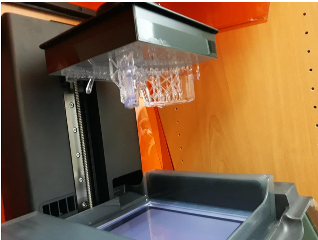
Ilustración 25: Impresión finalizada en impresora 3D.
