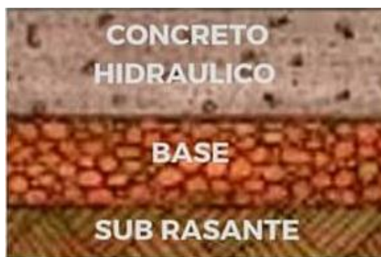
Figura N° 02: Estructura típica de Pavimento Rígido.
