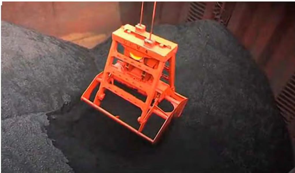
*Figura 8.* Grúa recogiendo material utilizando un cucharón de almeja.
