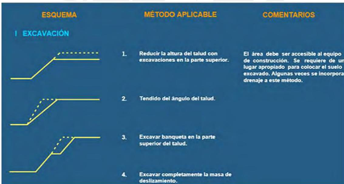
*Figura 6.* Proceso de excavación de rampa a banqueta
