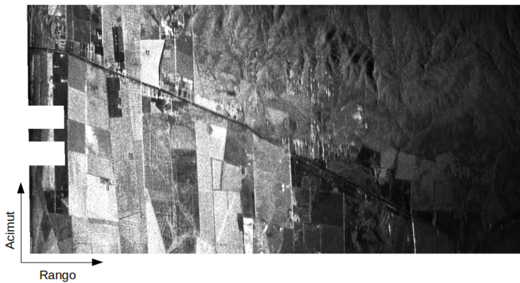
Figura 4.14: Imagen SLC-53 hh resultado del enfoque utilizando el algoritmo BP.
