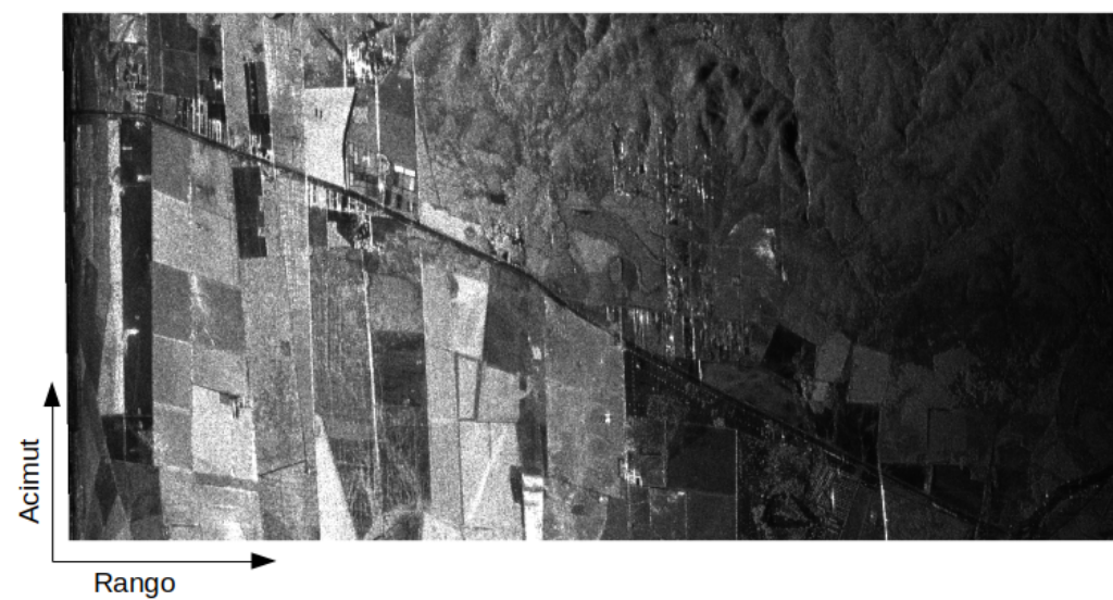
Figura 4.5: Imagen SLC-19 hh resultado del enfoque utilizando el algoritmo BP.
