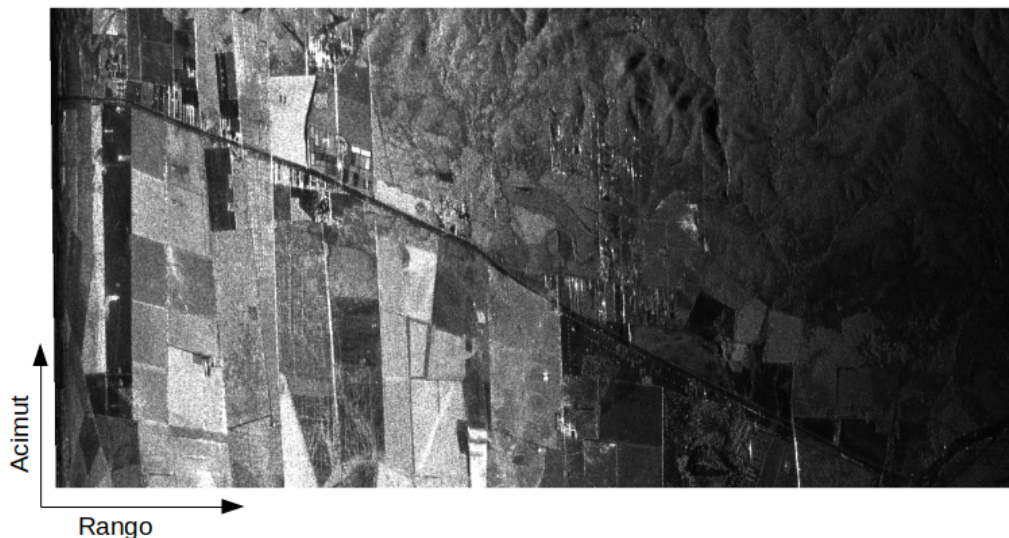
Figura 4.10: Imagen SLC-19 hh resultado del enfoque utilizando el algoritmo BP.
