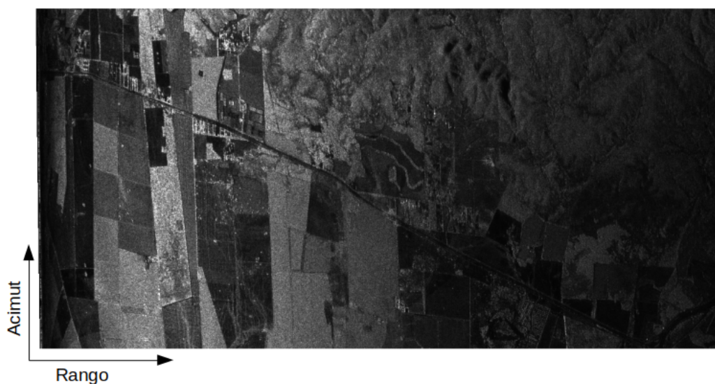
Figura 4.4: Imagen SLC-19 vh resultado del enfoque utilizando el algoritmo BP.
