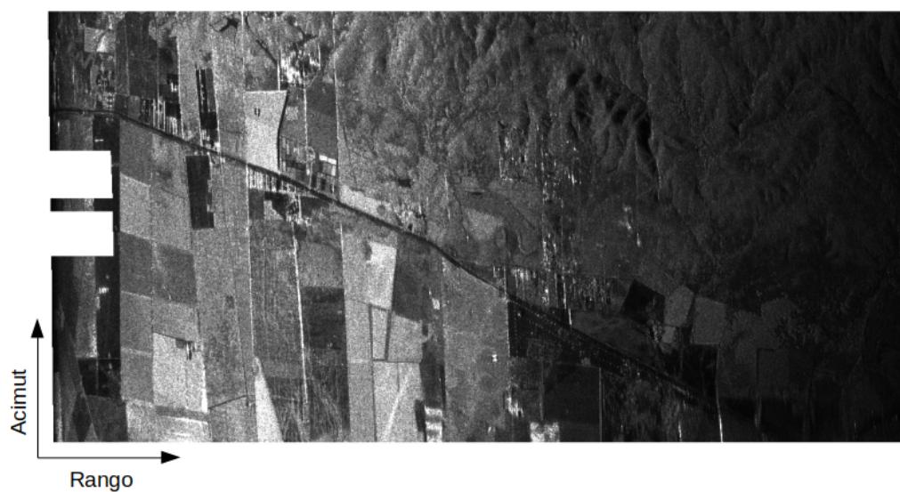
Figura 4.12: Imagen SLC-33 hh resultado del enfoque utilizando el algoritmo BP.
