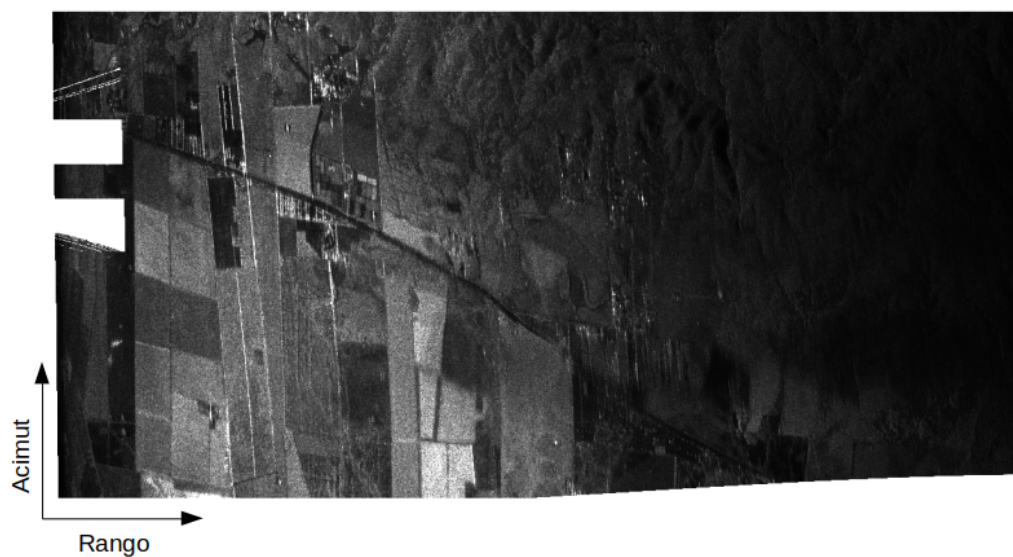
Figura 4.15: Imagen SLC-43 hh resultado del enfoque utilizando el algoritmo BP.
