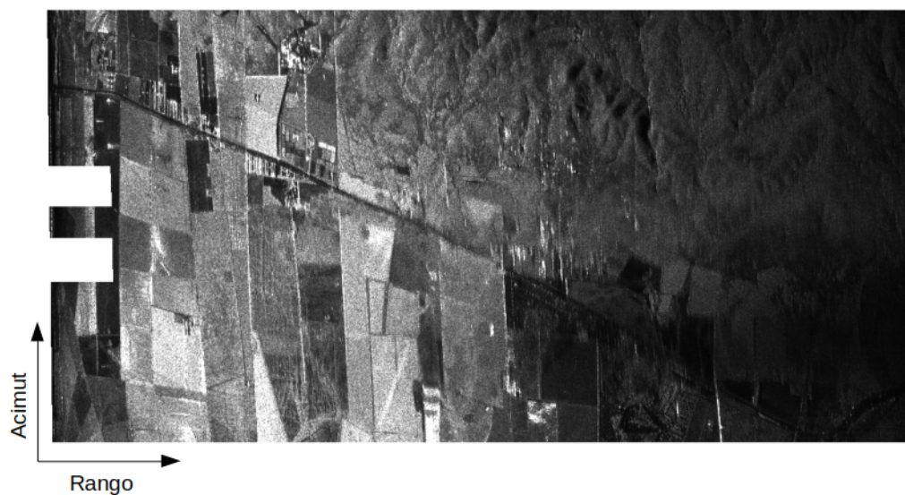
Figura 4.11: Imagen SLC-29 hh resultado del enfoque utilizando el algoritmo BP.
