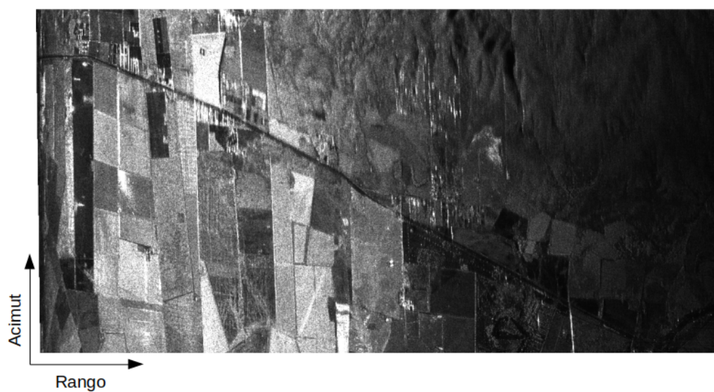
Figura 4.13: Imagen SLC-50 hh resultado del enfoque utilizando el algoritmo BP.
