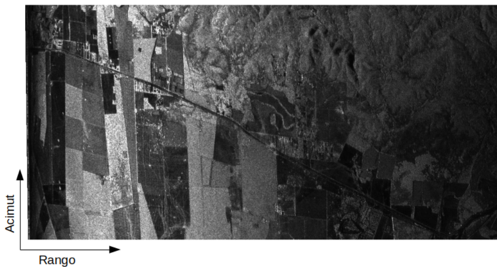
Figura 4.3: Imagen SLC-19 hv resultado del enfoque utilizando el algoritmo BP.
