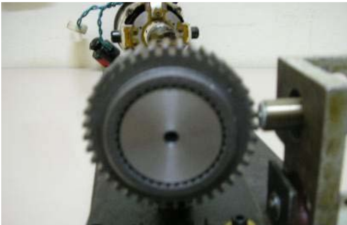
Figura 17-c – Dispositivo de puesta a punto (ubicación del sensor magnético )
