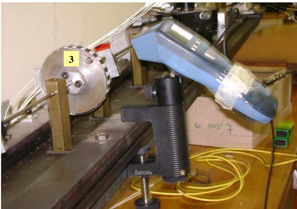
Figura 20 – Montaje del sensor óptico
