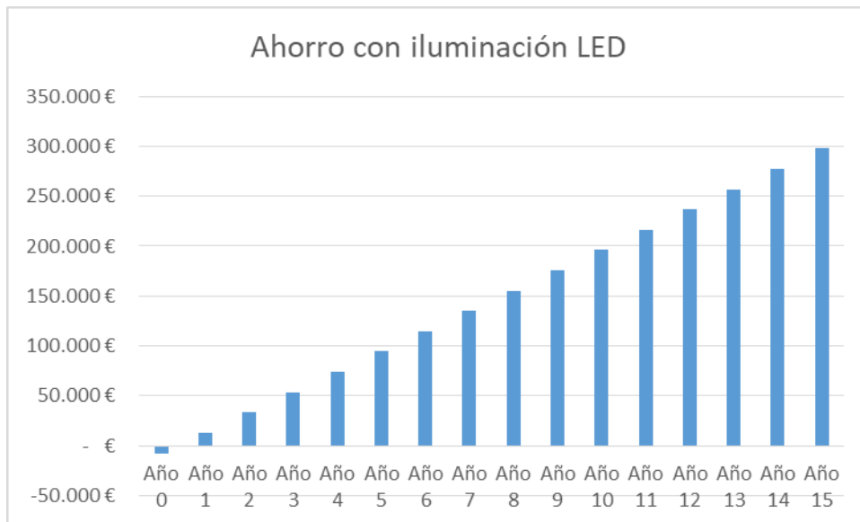
Figura 20. Previsión de ahorro producido por la sustitución de luminarias existentes por iluminación LED
