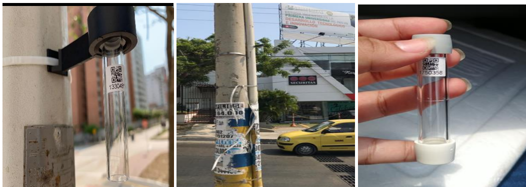
Figura 8. Monitoreo con los muestreadores pasivos (tubos Palmes para captación de \text{NO}_2 )
