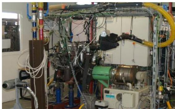
**Figura 3.1** Motor policilíndrico con freno dinamométrico utilizado en validación experimental.
