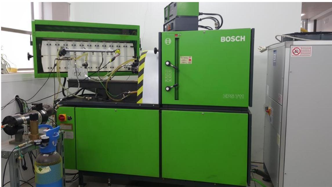
**Figura 3.4** Banco de prueba sistema de inyección Common Rail.
