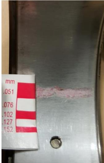
**Figura 4.17** Validación de tolerancias del motor en estudio.
