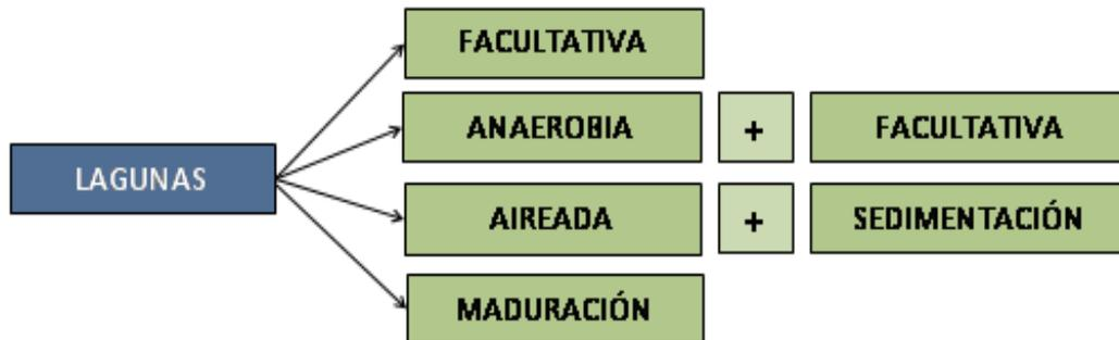
Fig. 2. Tipos de lagunas de estabilización
