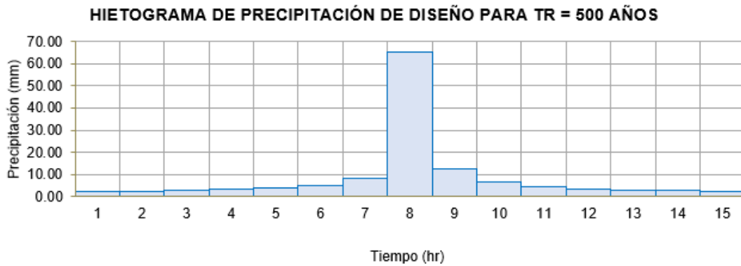
Figura 48. Hietograma de diseño para un TR de 500 años de la subcuenca SC-01
