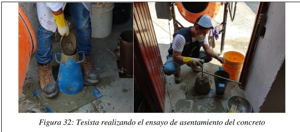
*Figura 32: Tesista realizando el ensayo de asentamiento del concreto*
