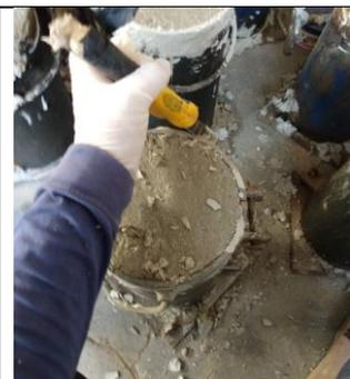
*Figura 42: Desencofrado de probetas*
