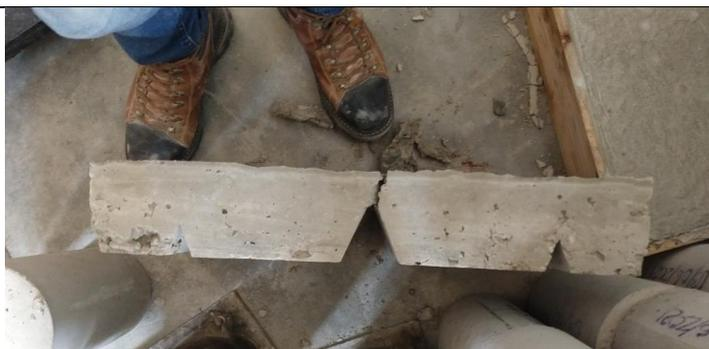
*Figura 68: Desencofrado de probetas*
