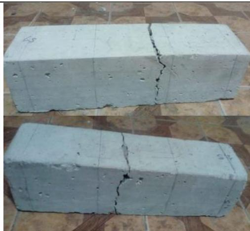
Figura 233: Falla presentada tras el ensayo de flexión a los 28 días para el concreto + PEG 0.5% (1 y 2)
