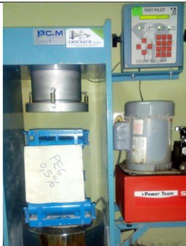
Figura 224: Carga resistida tras el ensayo de flexión a los 28 días para el concreto + PEG 0.5% (1)
