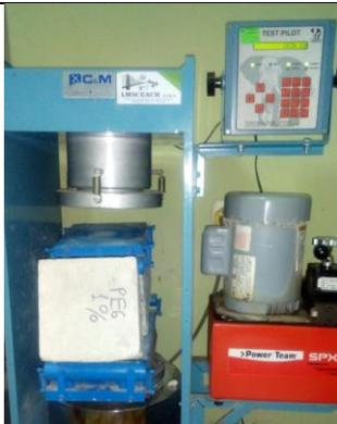
Figura 228: Carga resistida tras el ensayo de flexión a los 28 días para el concreto + PEG 1% (1)
