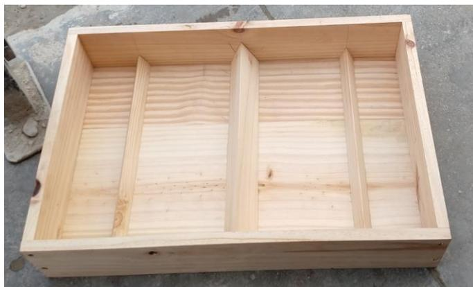
*Figura 66: Molde con dimensiones normalizadas*
