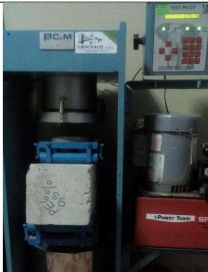
Figura 225: Carga resistida tras el ensayo de flexión a los 28 días para el concreto + PEG 0.5% (2)
