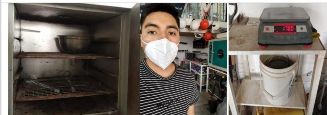
*Figura 22: Muestra colocada en el horno y peso de la muestra en la canastilla*
