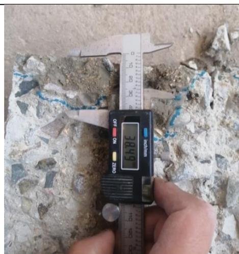
*Figura 57: Medida de la profundidad máxima penetrada ignorando la coquera*
