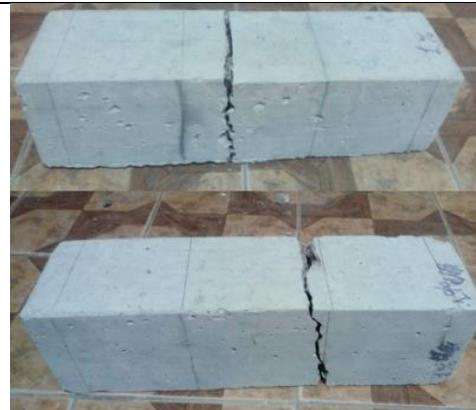
Figura 230: Falla presentada tras el ensayo de flexión a los 28 días para el concreto + PEG 0.5% (1 y 2)
