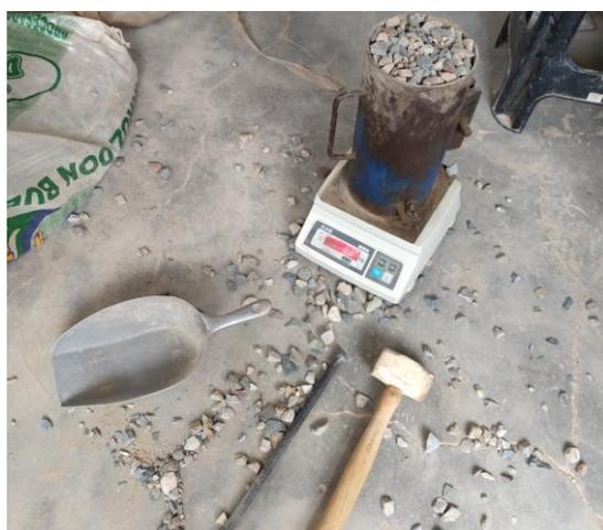
*Figura 16: Instrumentos empleados para determinar el peso unitario del agregado*
