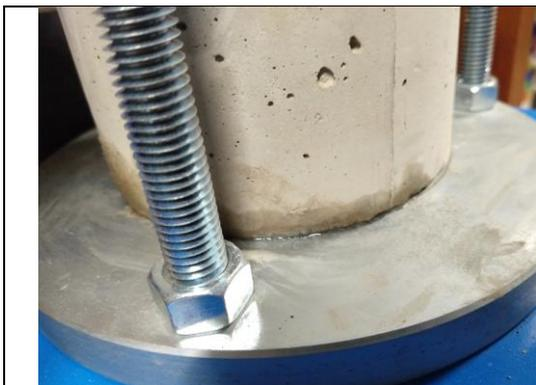
*Figura 58: Encharcamiento en probeta PEG 1%*
