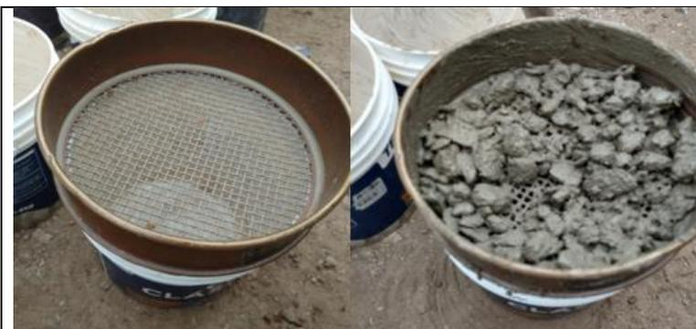
*Figura 60: Tamizado de la mezcla de concreto*
