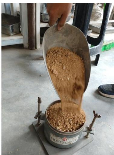
*Figura 18: Llenado de las capas de agregado fino*
