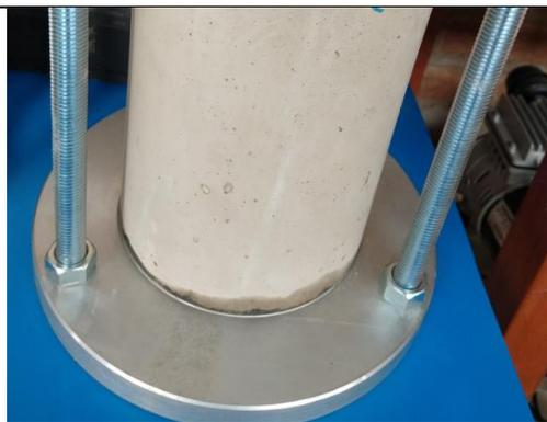
*Figura 59: Encharcamiento en probeta PEG 0.5%*
