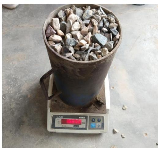
*Figura 17: Peso del molde más el agregado grueso contenido*
