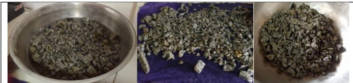
*Figura 20: Saturación y secado superficial de la muestra de la cantera El Pedregal - Reque*
