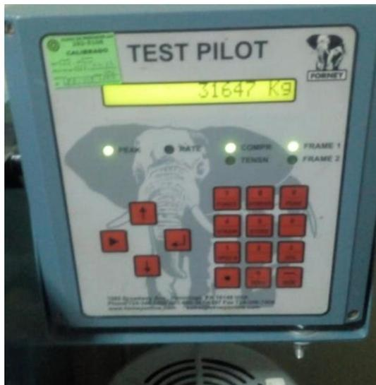
Figura 146: Carga resistida a los 28 días para el concreto + PEG 1.5% (1)
