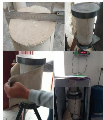
*Figura 45: Procedimiento realizado para la rotura de probetas*
