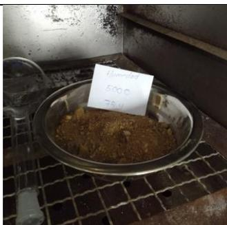
*Figura 15: Muestra de agregado puesta en el horno precalentado*
