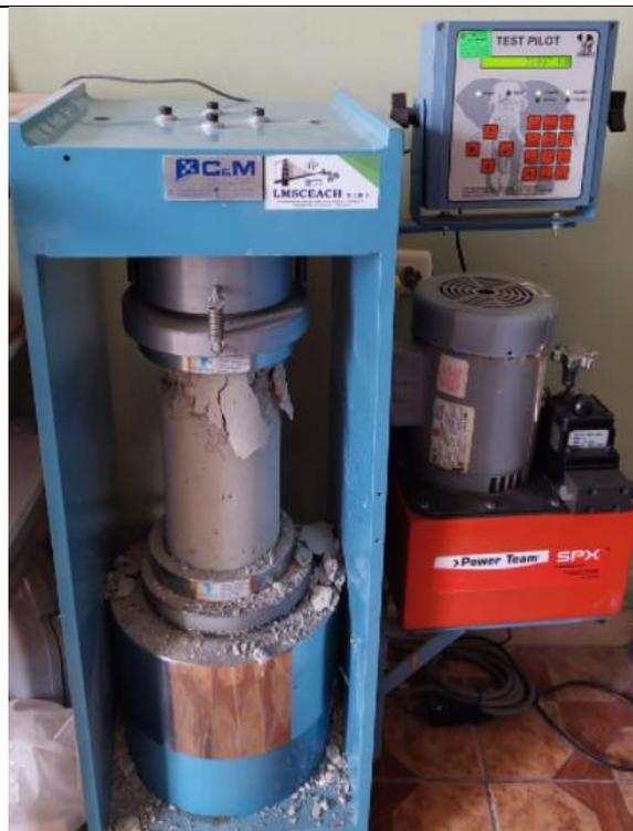
*Figura 137: Carga resistida y falla presentada tras el ensayo de compresión a los 56 días para el concreto + PEG 1% (2)*
