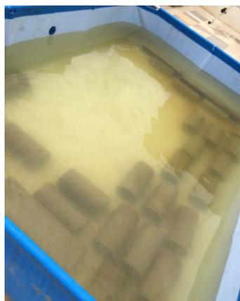
*Figura 43: Curado de probetas para concreto patrón sumergidas en agua*
