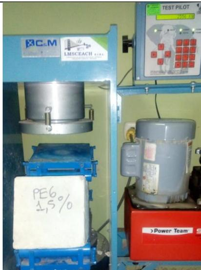
Figura 231: Carga resistida tras el ensayo de flexión a los 28 días para el concreto + PEG 1.5% (1)
