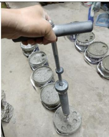
*Figura 64: Realización del ensayo de tiempo de fraguado*
