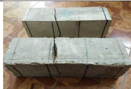
Figura 223: Falla presentada tras el ensayo de flexión a los 28 días para el concreto patrón (1 y 2)
