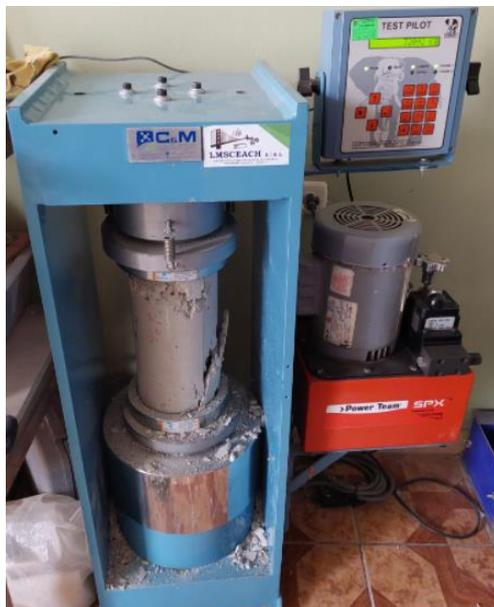
*Figura 136: Carga resistida y falla presentada tras el ensayo de compresión a los 56 días para el concreto + PEG 1% (1)*
