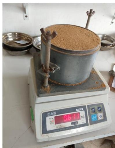
*Figura 19: Peso del molde más el agregado grueso contenido*
