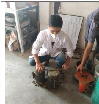
*Figura 40: Moldeado de probetas*
