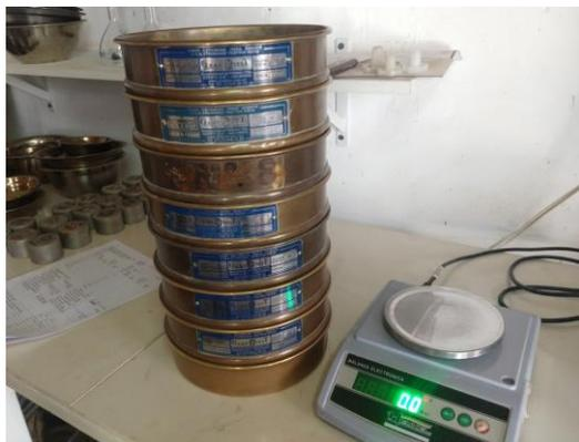
*Figura 13: Tamices normalizados para agregado fino*
