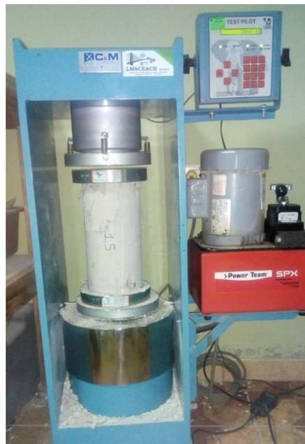
Figura 147: Falla presentada tras el ensayo de compresión a los 14 días para el concreto + PEG 1.5% (1)
