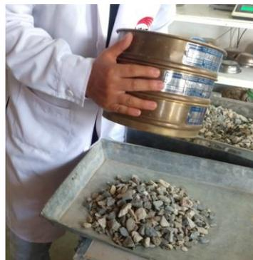
*Figura 14: Tesista realizando el ensayo de granulometría al agregado grueso con tamices normalizados*
