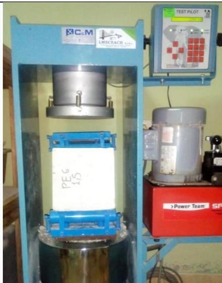
Figura 232: Carga resistida tras el ensayo de flexión a los 28 días para el concreto + PEG 1.5% (1)
