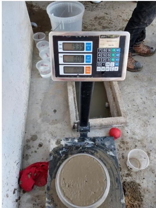
Figura 94: Control de pesos para el concreto + PEG 0.5%
