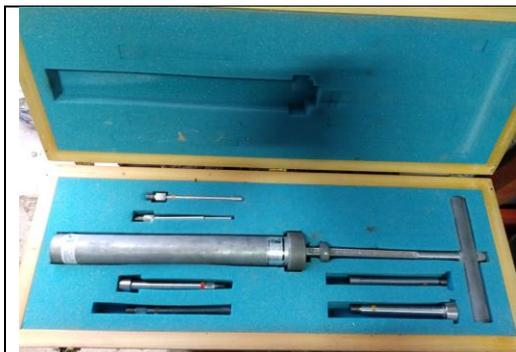
*Figura 62: Penetrómetro*
