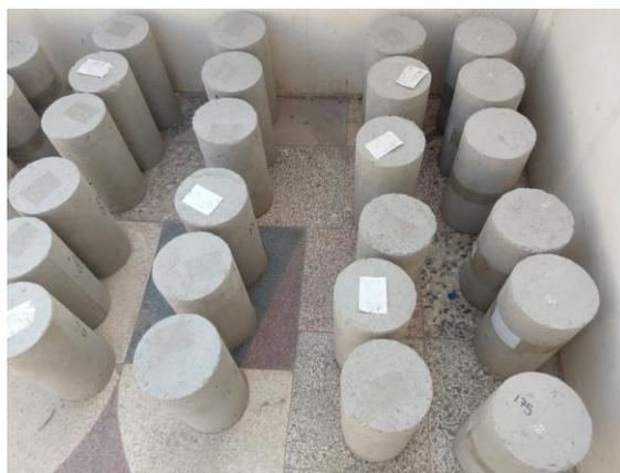
*Figura 44: Probetas para concreto con aditivo expuestas a la intemperie en una zona sin sombra*
