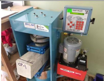
Figura 221: Carga resistida tras el ensayo de flexión a los 28 días para el concreto patrón (1)
