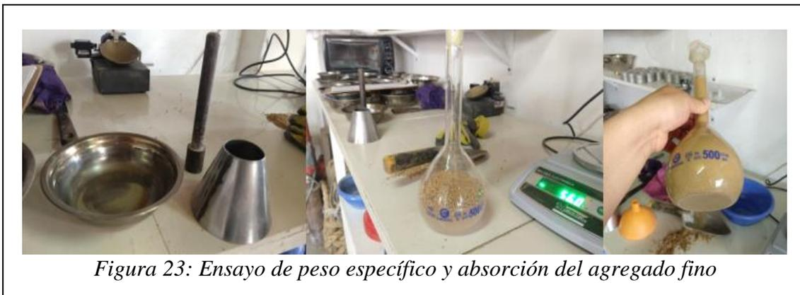
*Figura 23: Ensayo de peso específico y absorción del agregado fino*
