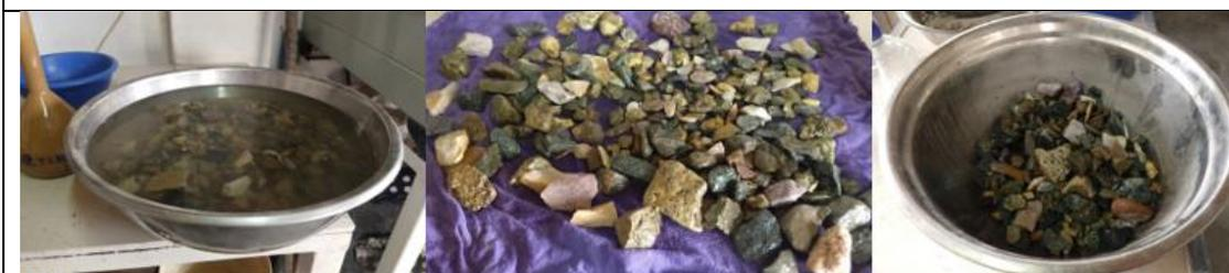
*Figura 21: Saturación y secado superficial de la muestra de la cantera Tres Tomas - Ferreñafe*
