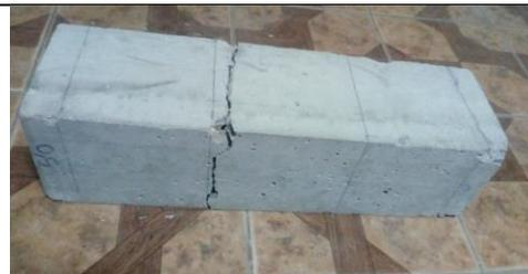
Figura 226: Falla presentada tras el ensayo de flexión a los 28 días para el concreto + PEG 0.5% (1)
