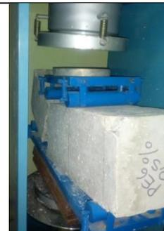
Figura 227: Falla presentada tras el ensayo de flexión a los 28 días para el concreto + PEG 0.5% (2)
