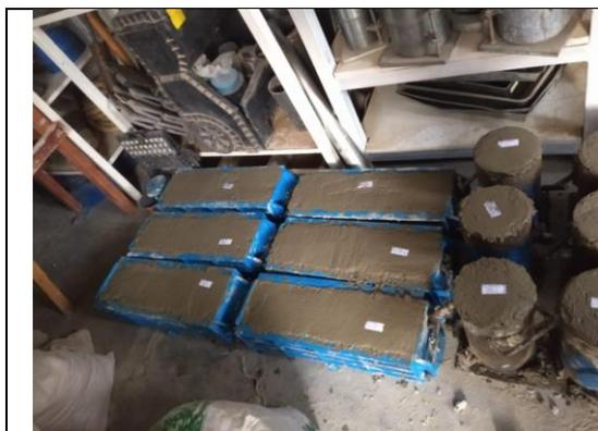
*Figura 71: Preparación de moldes para ensayo de flexión*
