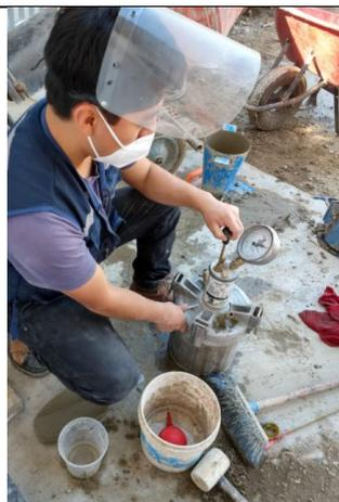
*Figura 36: Tesista utilizando la olla Washington*
