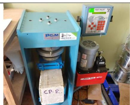
*Figura 75: Ensayo de flexión*
