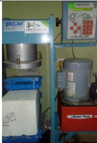
Figura 229: Carga resistida tras el ensayo de flexión a los 28 días para el concreto + PEG 1% (1)
