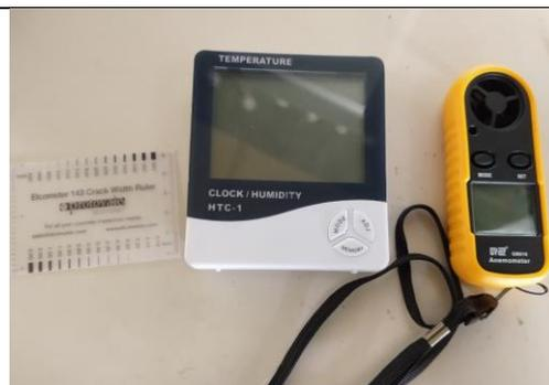
*Figura 69: Tarjeta para medir ancho de fisuras, Anemómetro - termómetro, e higrómetro*
