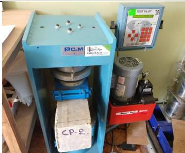
Figura 222: Carga resistida tras el ensayo de flexión a los 28 días para el concreto patrón (2)
