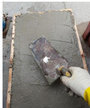
*Figura 67: Llenado del molde para fisuración*
