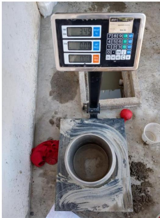
*Figura 98: Control de peso del molde*
