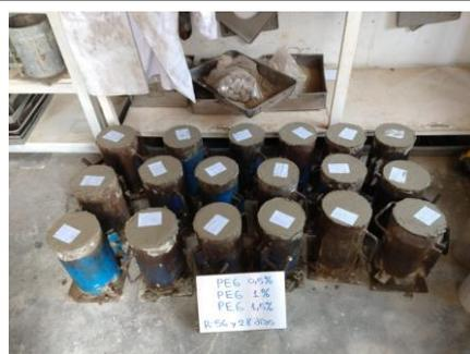
*Figura 41: Probetas para el ensayo de resistencia a la compresión*
