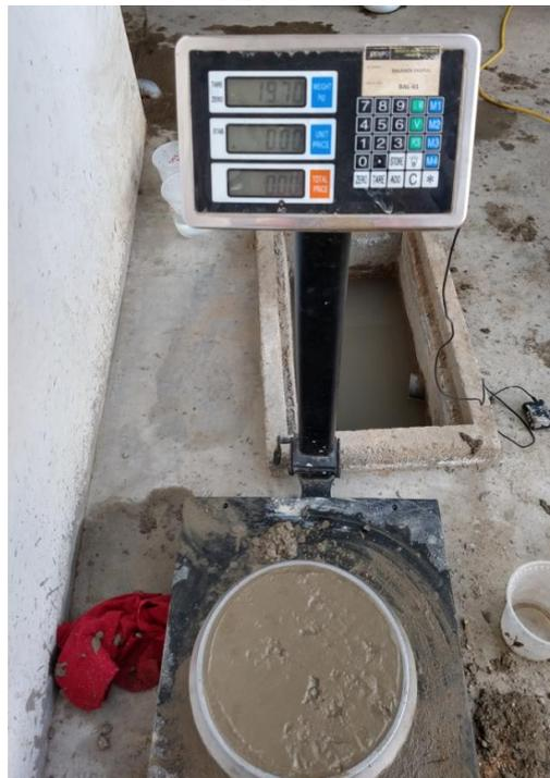
Figura 96: Control de pesos para el concreto + PEG 1.5%
