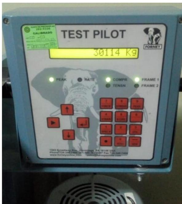
Figura 148: Carga resistida a los 28 días para el concreto + PEG 1.5% (2)
