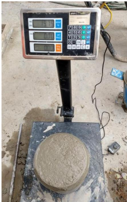
Figura 95: Control de pesos para el concreto + PEG 1%
