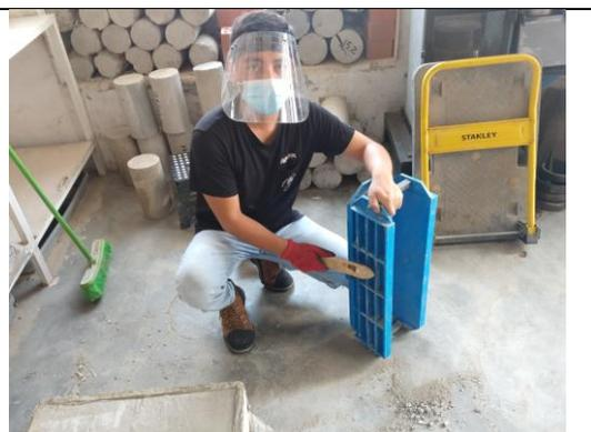
*Figura 72: Preparación de moldes para ensayo de flexión*
