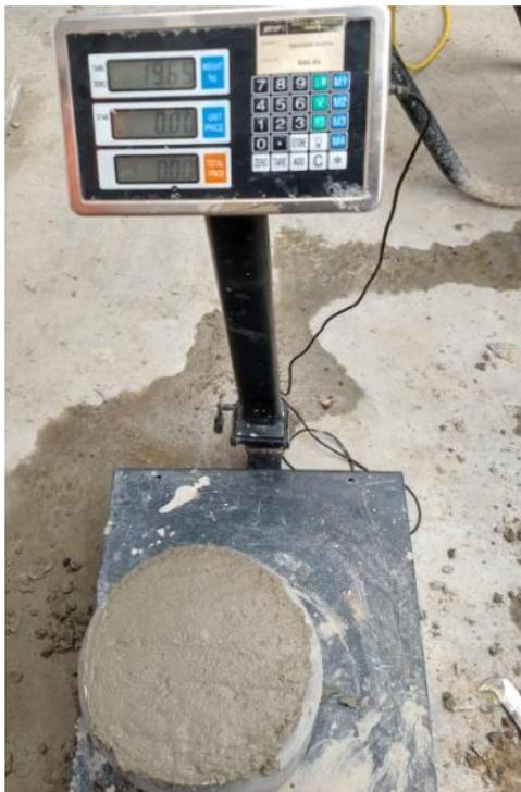
*Figura 97: Control de pesos para el concreto + PEG 1.75%*
