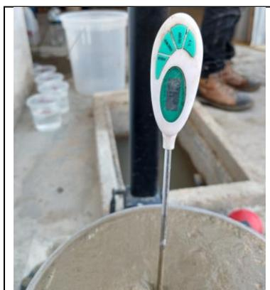
*Figura 37: Control de temperatura del concreto*
