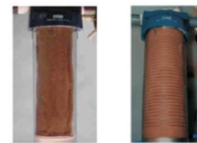
Fotografía 1 Estructura comprimida frente a estructura rígida a 2,4 bar
