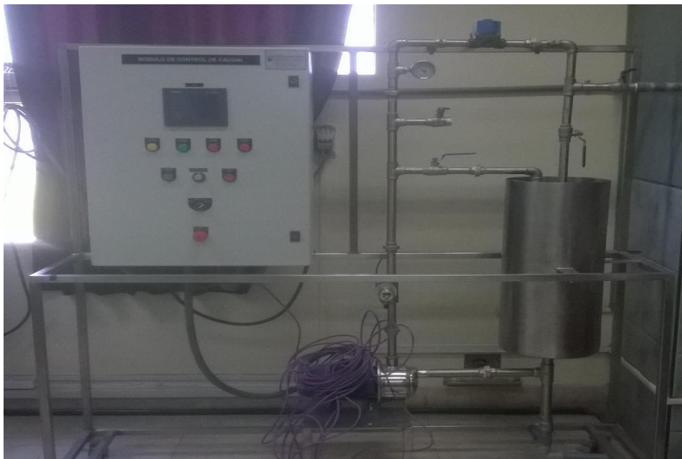
Figura 3: Módulo de Control de Caudal.
