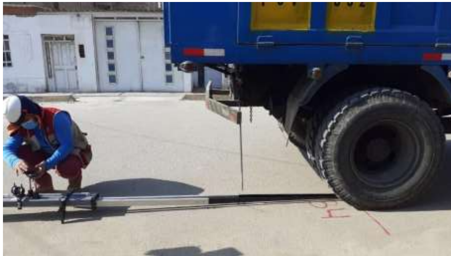
Camión utilizado para la deflectometría y Viga Benkelman de dos brazos.
