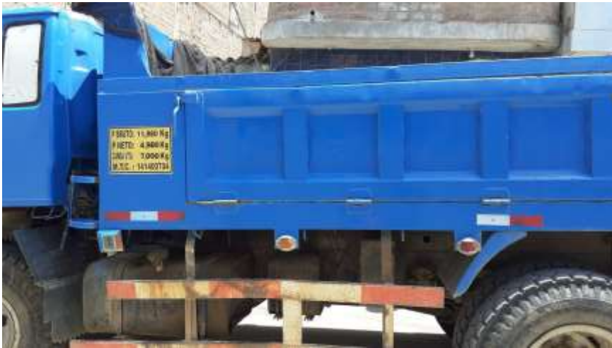
Camión estándar para ensayo de deflectometría
