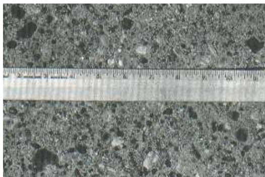
Ilustración 93: Pulimento de agregados
