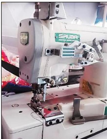
**Figura 12. Máquina Recubridora**
