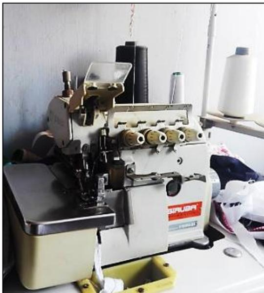
**Figura 11. Máquina Remalladora**
